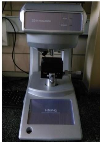
Ilustración 20 Equipo de microindentación Shimadzu Micro-Vickers (modelo HMV-G)
