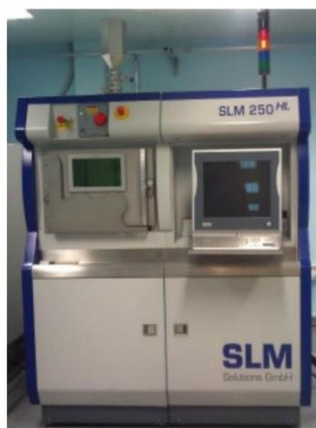
Ilustración 19 Equipo SLM 250<sup>HL</sup> (Solutions GmbH)
