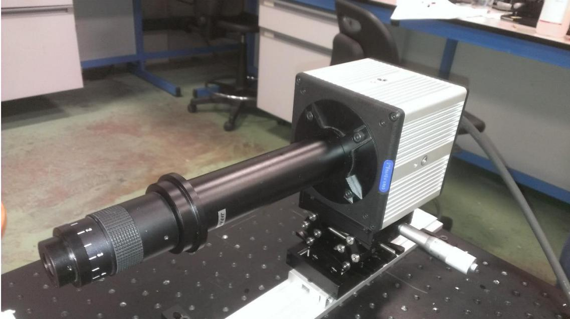
Figura 3-7. Cámara de alta velocidad.
