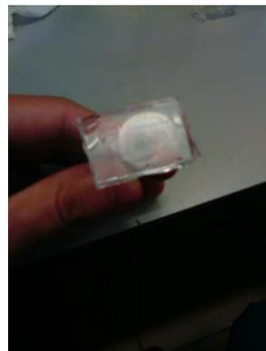
Figura 4-8. La burbuja adquiere forma circular, aunque no siempre se extiende radialmente toda la muestra.
