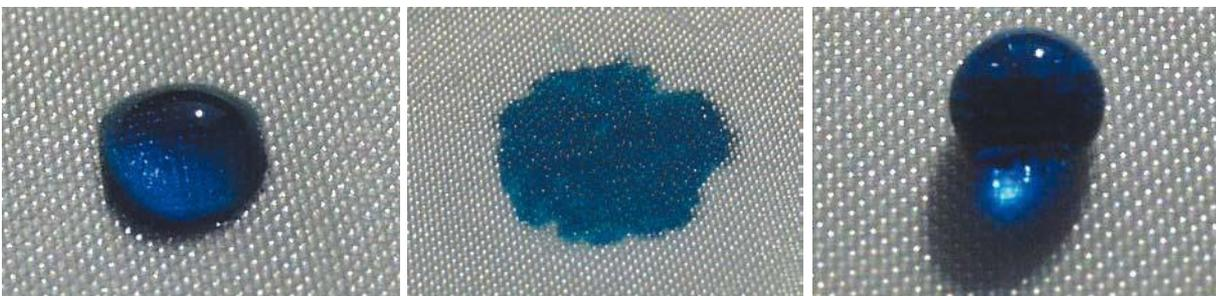
Figura 3-8. Podemos apreciar en las imágenes, respectivamente, una superficie de algodón sobre la cual se aplica el líquido con colorante azul, una superficie donde se aplica un recubrimiento hidrófilico y otra en la cual se aplica un recubrimiento hidrófóbico.
