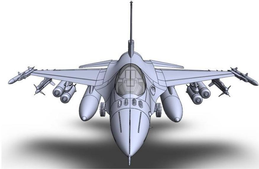
Figura 68 Resultado del diseño de un F-16 mediante el software SolidWorks. Imagen tomada de (27).
