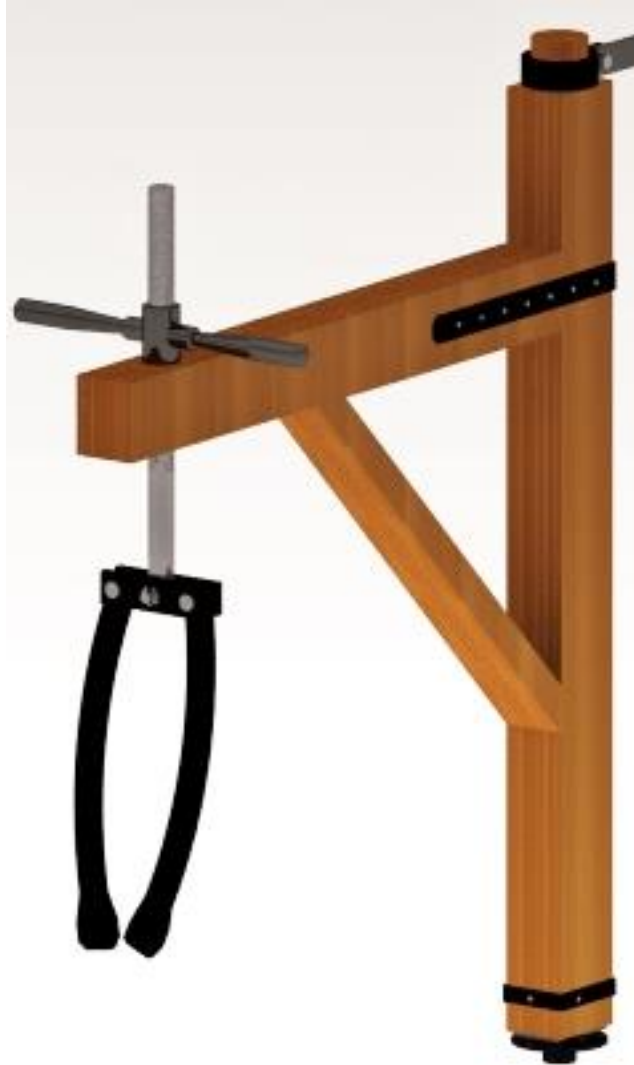
Figura 105 Vista general del conjunto cabria.
