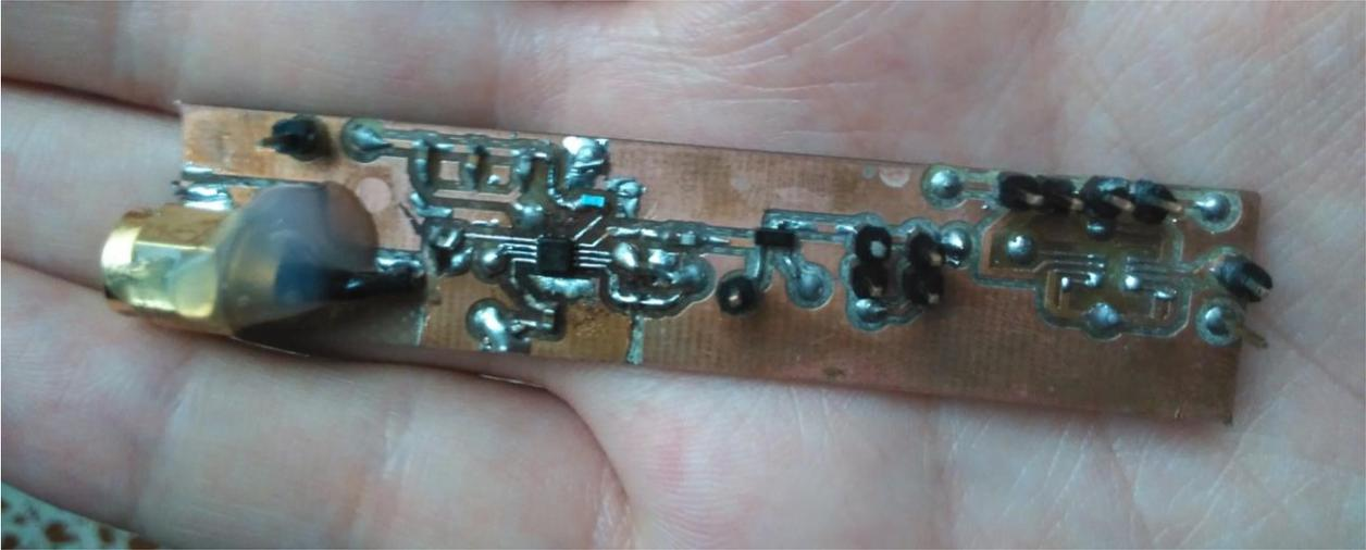
Figura 3-46 Receptor implementado
