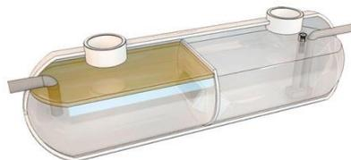
Figura 21 Separador de hidrocarburos
