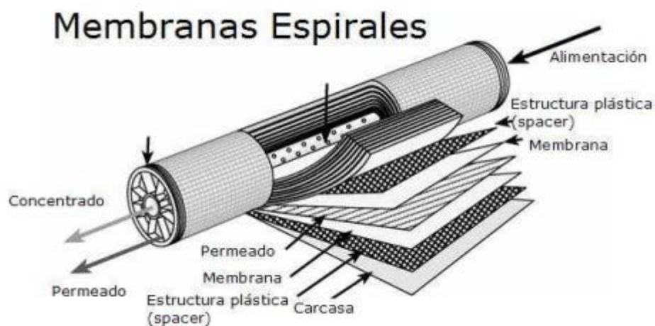
**Ilustración 13. Membrana de módulo en espiral**
