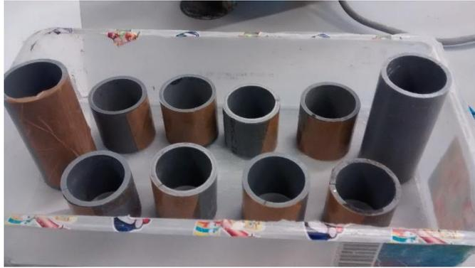
7. Una vez rellenos llevar todos los moldes para su fraguado a un horno a 60 °C (este parámetro se mantiene para todas las mezclas) durante 24 h.
