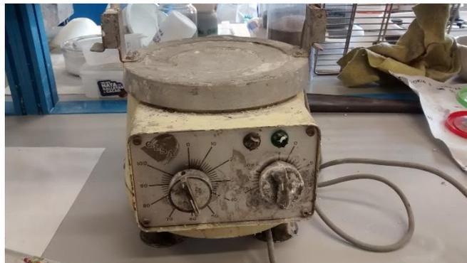
6. Rellenar los moldes de PVC (poner los moldes en una caja de plástico y rellenarlos mientras vibran). Procurar no llenarlos hasta arriba (para facilitar el desmolde) y mantenerlos un breve tiempo para que salgan las posibles burbujas de aire.
