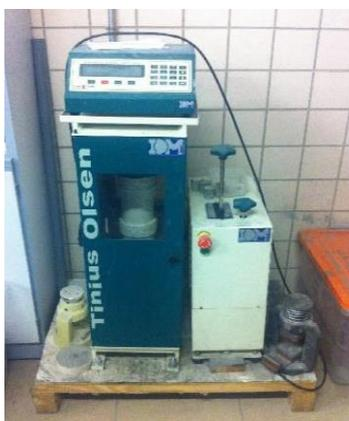
La resistencia a compresión se ha medido, en la medida que ha sido posible, según el procedimiento indicado en la norma ASTM E 761-86. Esta norma establece que la resistencia a compresión se determinará mediante la aplicación de una fuerza de compresión normal a la superficie de la muestra, midiendo la tensión aplicada al 0% de deformación, o cuando ocurra la rotura del material, si esta tiene lugar antes de alcanzar dicha deformación.
