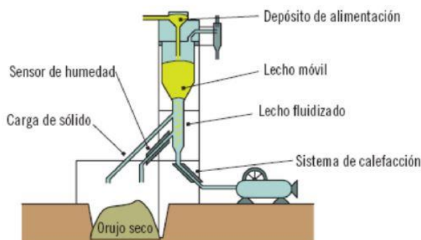
Figura 20. Secadero en lecho fluido o móvil
