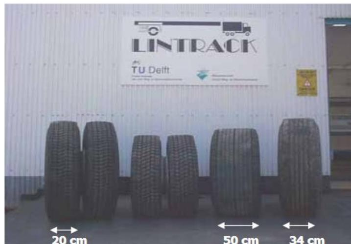
Ilustración 18 Diferentes tipo de rueda. De izquierda a derecha. 1, Rueda Gemela Estándar o Dual Tire. 2, Rueda gemela pequeña. 3, Super super single tire. 4 Rueda simple o super single Tire
