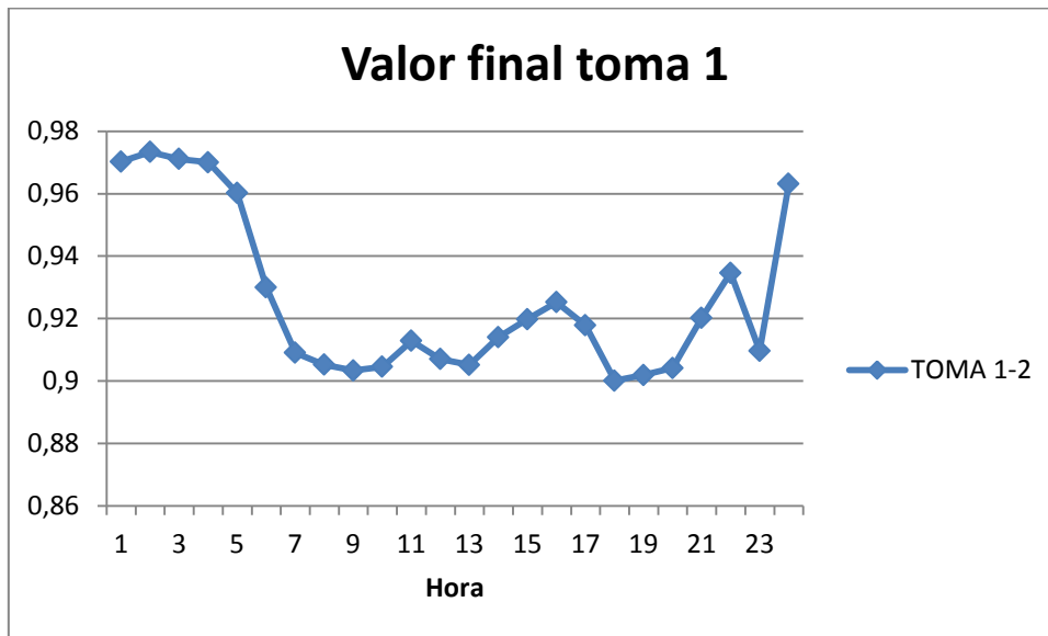
Figura 5.1.3.6-3. Valor final de la toma del trafo 1. Sintonización sin GD discreto. Caso 6.
