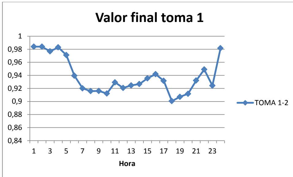
Figura 5.1.4.6-3. Valor final de la toma del trafo 1. Sintonización con GD continuo. Caso 6.
