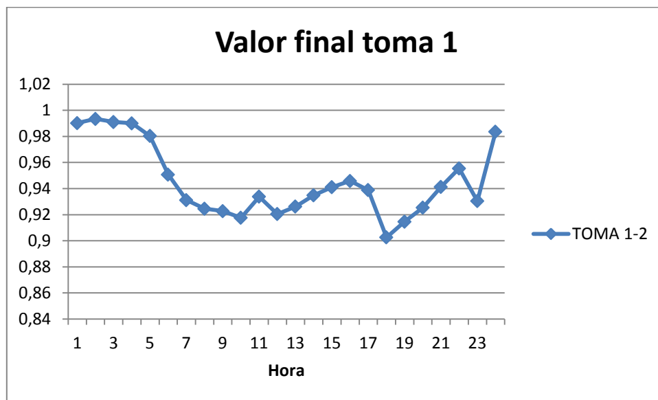
Figura 5.1.3.5-3. Valor final de la toma del trafo 1. Sintonización sin GD discreto. Caso 5.
