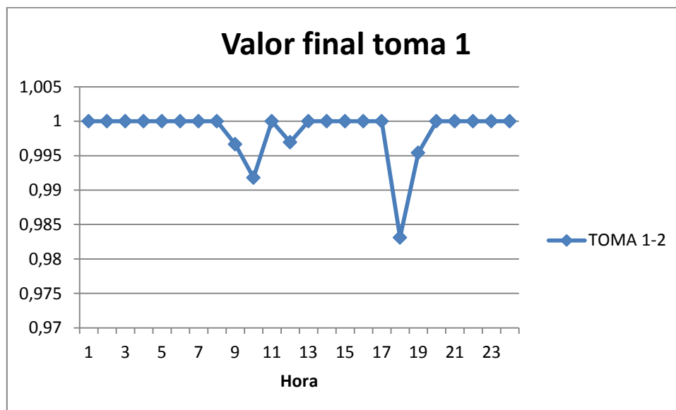
Figura 5.1.3.2-3. Valor final de la toma del trafo 1. Sintonización sin GD discreto. Caso 2.
