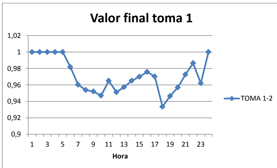
Figura 5.1.3.4-3. Valor final de la toma del trafo 1. Sintonización sin GD discreto. Caso 4.
