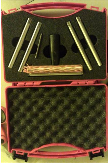
Figura 5-34 Set de rodillos para la deposición del pegamento
