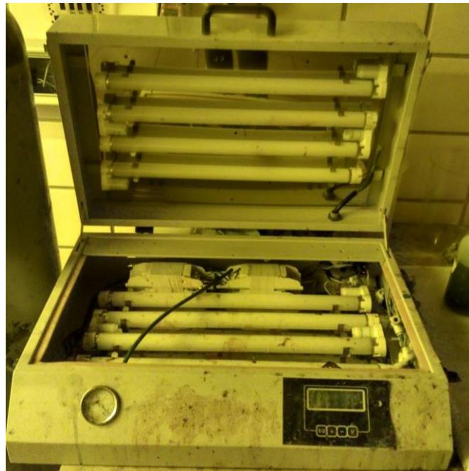
Figura 5-33 Máquina de insolación
