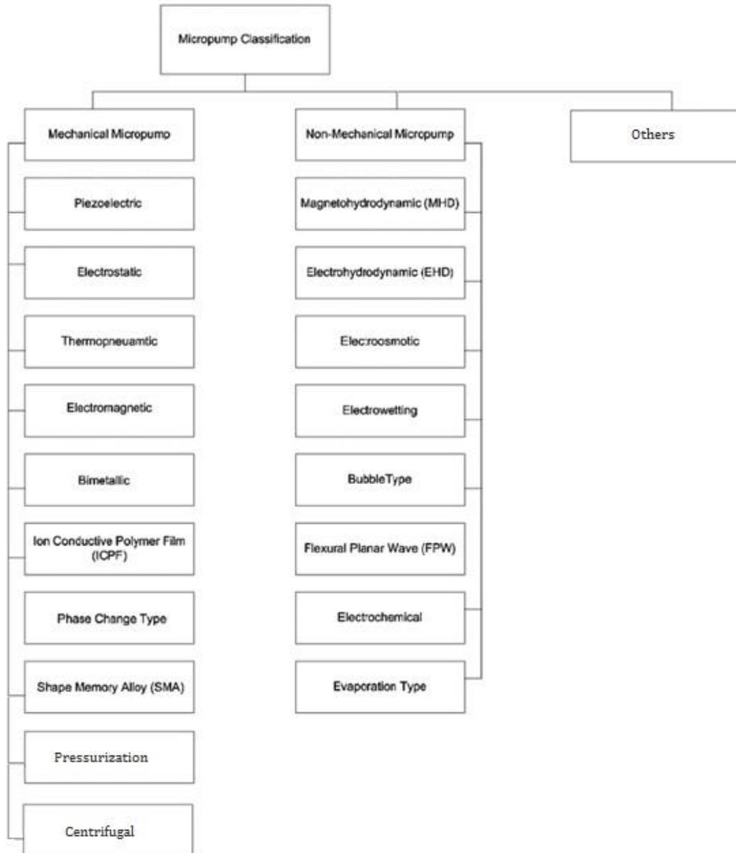
Figura 2-1 Clasificación de las microbombas
