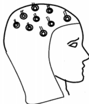
Principio de colocación de electrodos en casco de malla.
