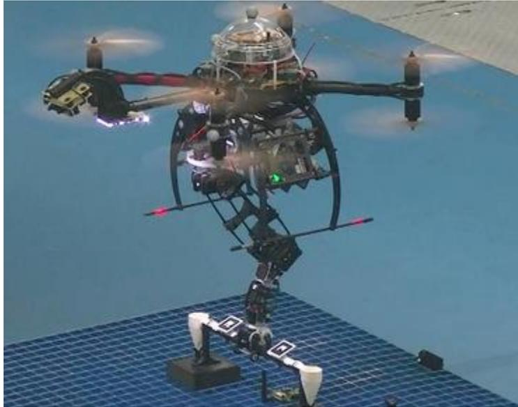
Figura 1: Robot aéreo del proyecto ARCAS: quadrotor en configuración co-axial con brazo robótico de seis grados de libertad.
