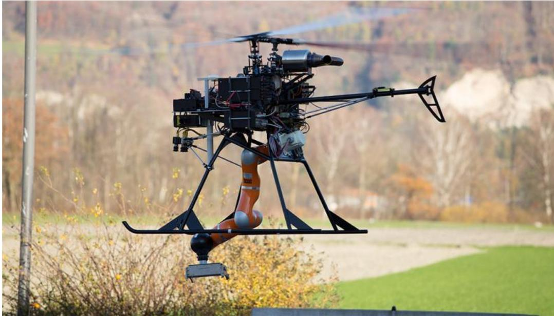
Figura 5: Helicóptero con brazo integrado de DLR
