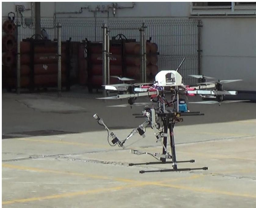
Figura 2: Multirotor equipado con dos brazos robóticos del proyecto AEROARMS.
