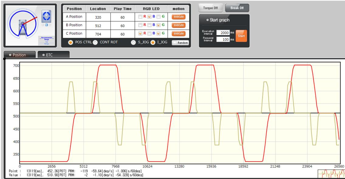
Figura 39: Funcionamiento normal del modo operacional con velocity over ride (se detiene al llegar a la posición).
