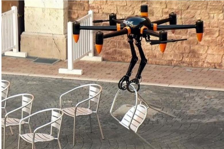
Figura 3: Manipulador aéreo del fabricante PRODRONE
