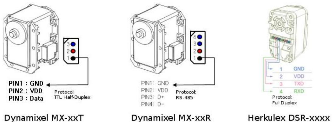
Figura 9: Interfaz física de comunicaciones en smart servos Dynamixel y Herkulex
