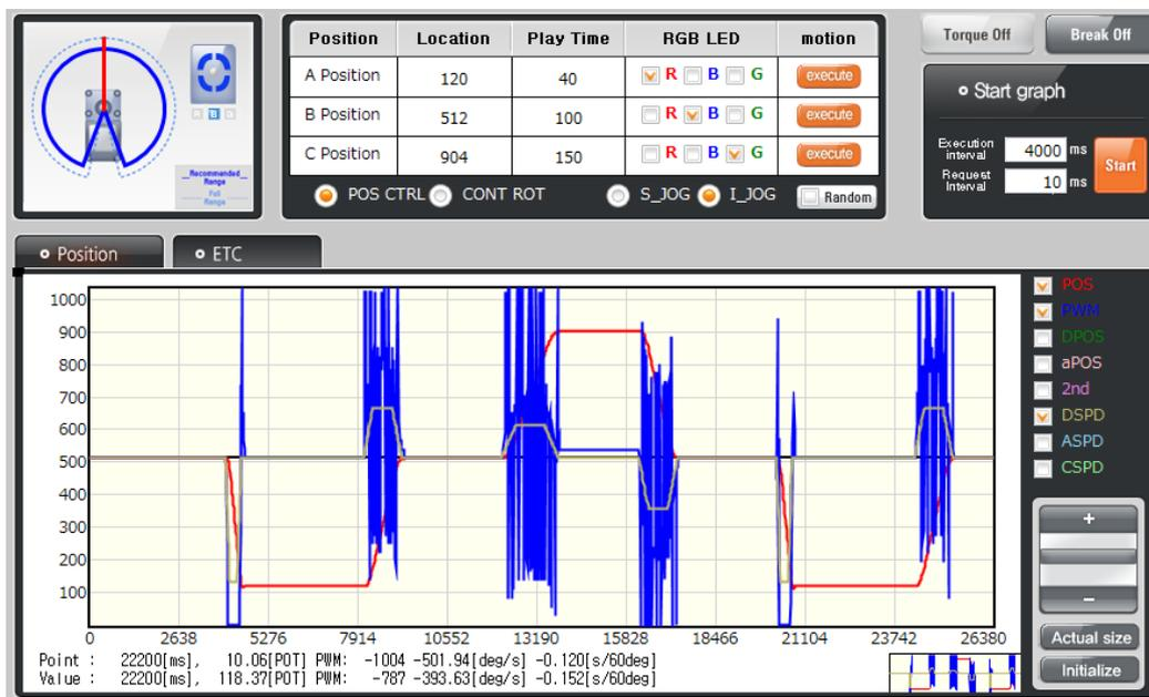
Figura 38: Señal PWM con variaciones en la velocidad de desplazamiento.
