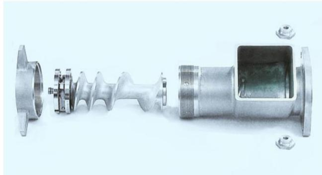
*Figura 3-30. Detalle tornillo sin fin con paso diferente en cada zona.*
