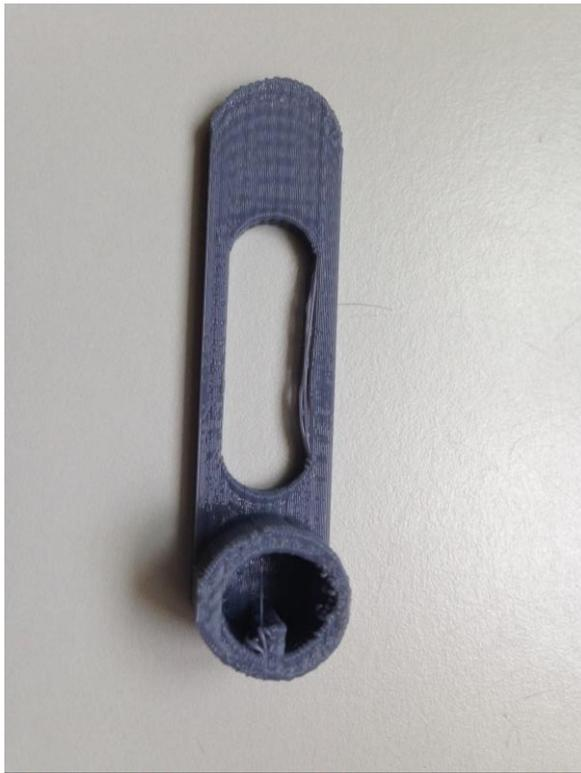
*Figura 4-31. Tercer intento en la máquina 1, buena forma, pero diámetro interior insuficiente.*
