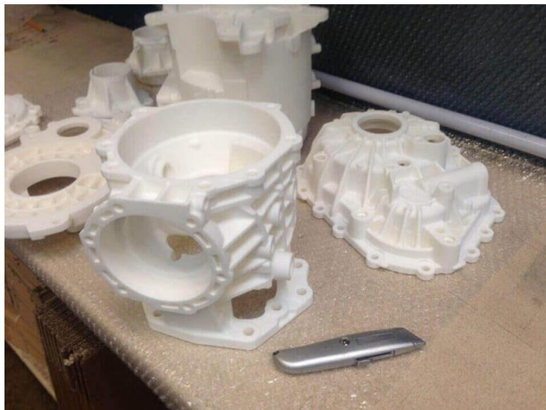
*Figura 1-10. Prototipado Rápido de una caja de cambios.*
