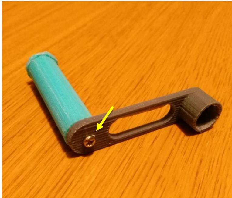
*Figura 4-52. Detalle del ensamblaje de las tres partes de la manivela.*
