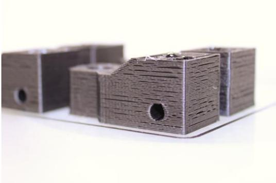
Figura 4-7. Separación de capas.
