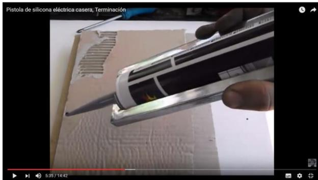
Figura 3-7. Parte delantera de una pistola de silicona actuada eléctricamente.
