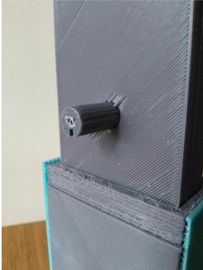
*Figura 4-57. Detalle de la parte trasera de la base con el tornillo sin fin pasando por el taladro realizado.*
