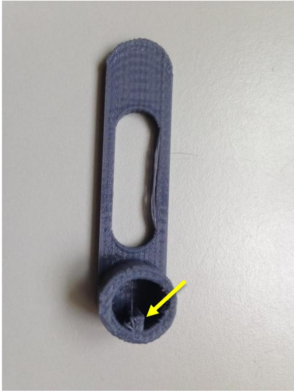
*Figura 4-49. Detalle saliente en la manivela.*
