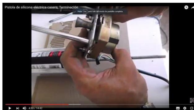
Figura 3-9. Motor de una pistola de silicona actuada eléctricamente.
