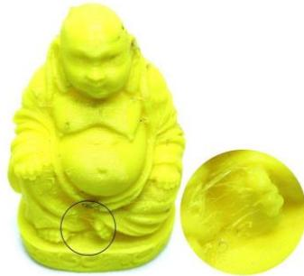
Figura 4-3. Detalle de hilos indeseados en una pieza.
