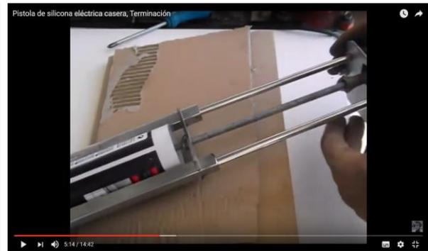
Figura 3-8. Parte central de una pistola de silicona actuada eléctricamente.
