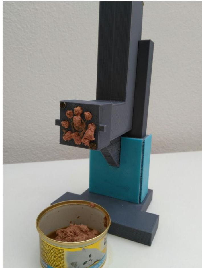
*Figura 5-9. Dispositivo después de dispensar comida húmeda de lata.*
