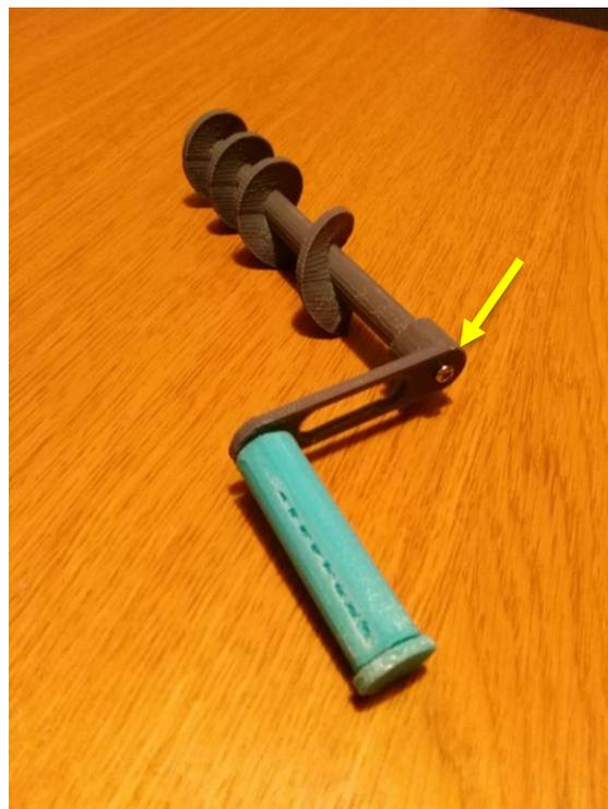
*Figura 4-51. Detalle de la manivela atornillada al sin fin.*
