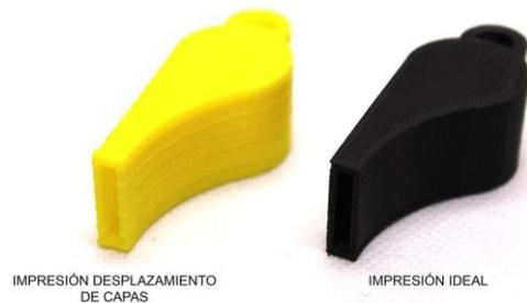
Figura 4-6. Deslizamiento de capas.
