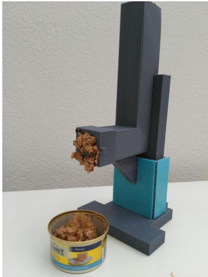
*Figura 5-13. Dispositivo después de dispensar comida húmeda de bolsa.*
