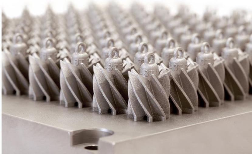
*Figura 1-12. Piezas en titanio fabricadas en masa.*
