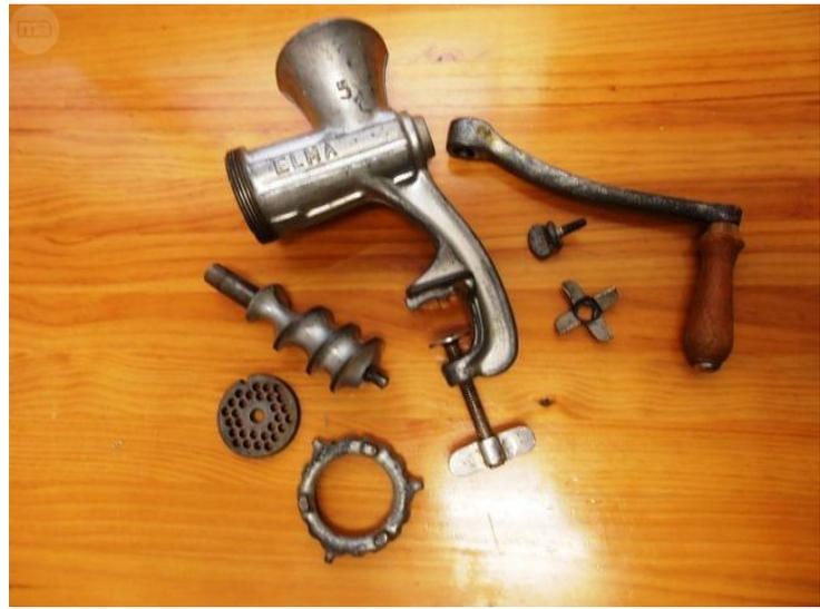
Figura 3-29. Máquina matancera desmontada.
