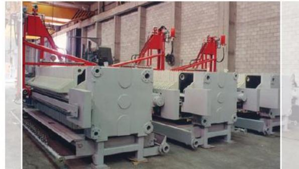
Foto 11: Filtro prensa de membrana
