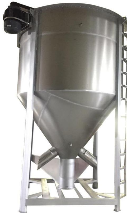
*Figura 2.2.1.2 Tanque agitador.*
