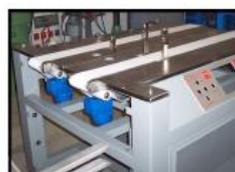
El tejado de las cortadoras EMC, montado con 4 tornillos en la cinta transportadora es el soporte de los grupos auxiliares, como encoder, rodillos de entrada y salida, rodillo prensador y bordes.
