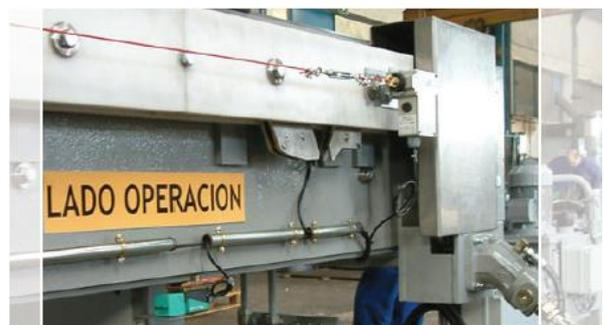
Foto 7: Sistema de transporte automático de placas
