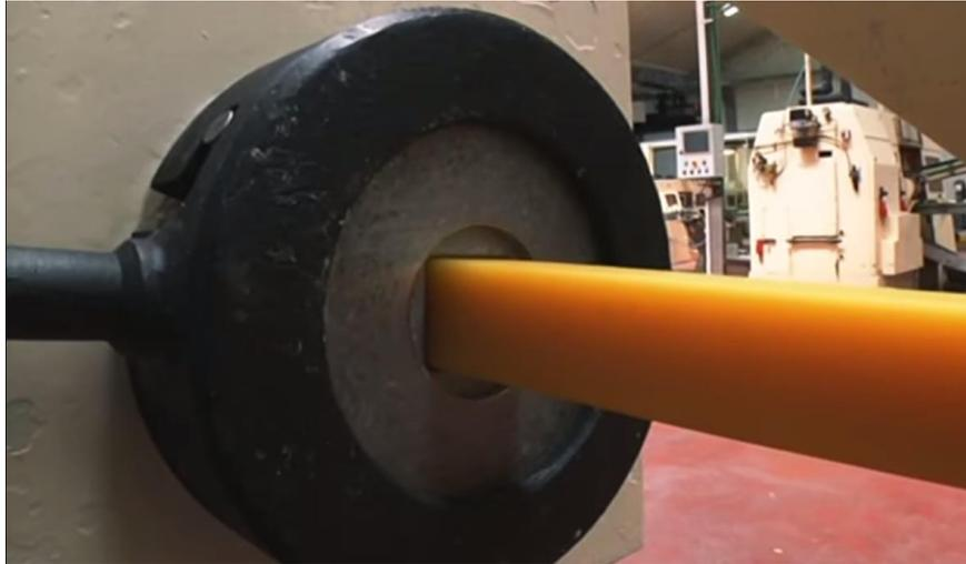
*Figura 2.4.2.2.1 Boquilla extrusora.*
