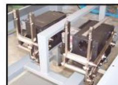
La cinta transportadora y la plataforma de trabajo de la cortadora son una única entidad, con 6 tornillos es posible desmontarlo del bastidor en caso de sustitución de la cinta.
