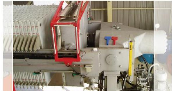
Foto 2: Mecanismo de cierre, Cabezal de accionamiento y móvil
