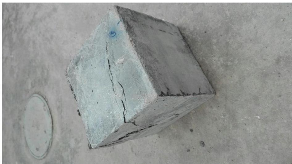
*Figura 4-30. Reportaje fotográfico. UHPFRC2-Compresión.*
