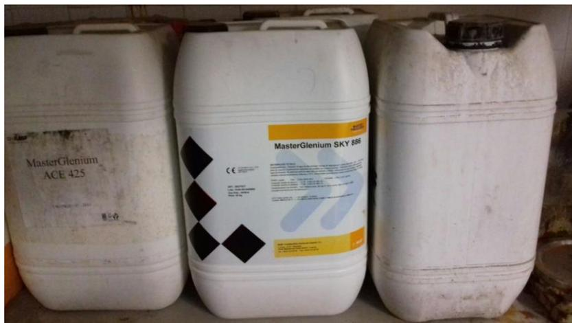
*Figura 4-6 Fabricación del hormigón. Material: Superplastificante.*
