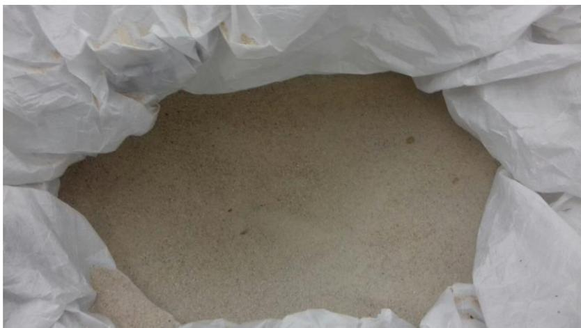
*Figura 4-4. Fabricación del hormigón. Material: Árido fino.*
