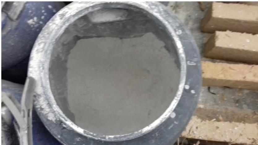
*Figura 4-3. Fabricación del hormigón. Material: Escoria de alto horno.*
