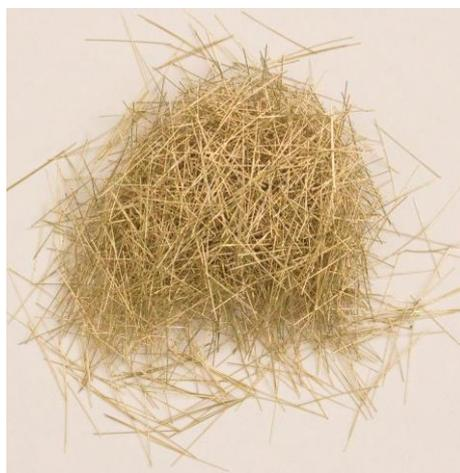
*Figura 4-7. Fabricación del hormigón. Material: Fibras de acero cortas.*
