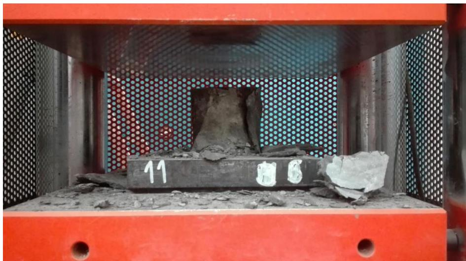
*Figura 4-33. Reportaje fotográfico. UHPC1-Compresión.*
