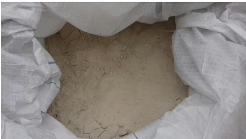
*Figura 4-5. Fabricación del hormigón. Material: Filler.*
