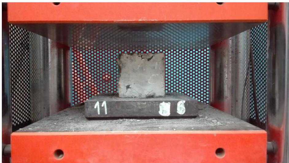
*Figura 4-32. Reportaje fotográfico. UHPFRC4-Compresión.*
