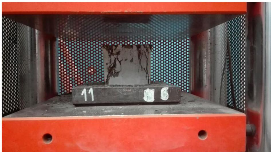
*Figura 4-29. Reportaje fotográfico. UHPFRC1-Compresión.*
