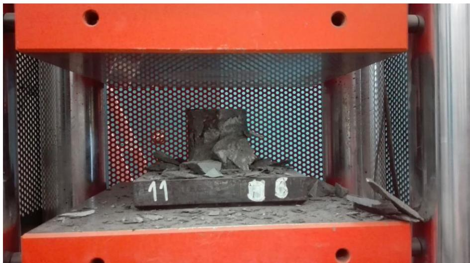
*Figura 4-35. Reportaje fotográfico. UHPC3-Compresión.*
