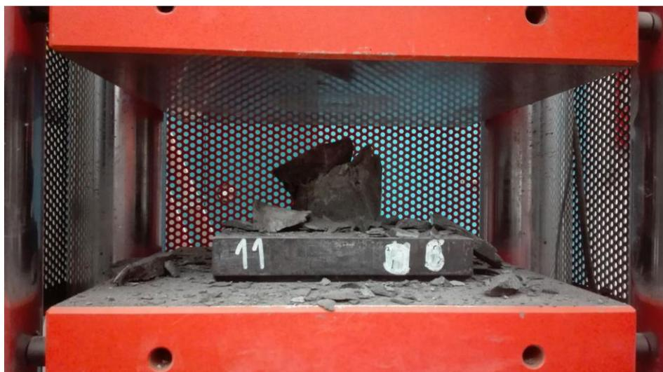
*Figura 4-34. Reportaje fotográfico. UHPC2-Compresión.*
