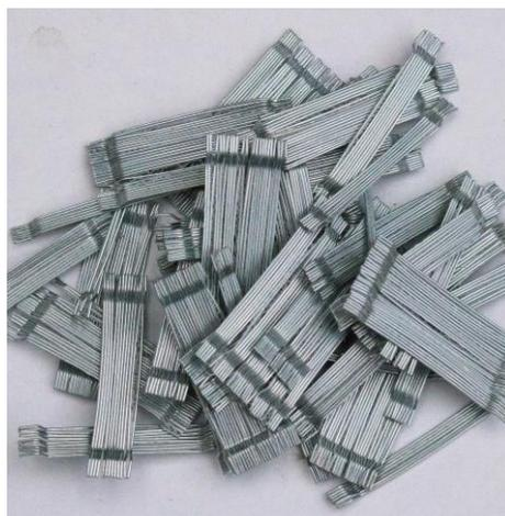
*Figura 4-8. Fabricación del hormigón. Material: Fibras de acero largas.*
