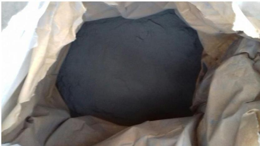
*Figura 4-2. Fabricación del hormigón. Material: Humo de sílice.*
