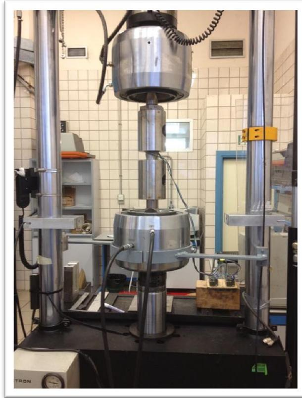
Figura 27. Conjunto montado en Instron 8833
