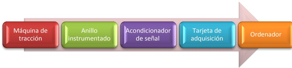
Figura 31. Esquema de las conexiones
