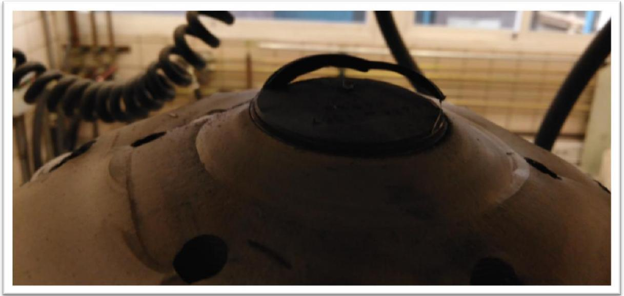
Figura 40. Célula de carga rota por fatiga 2
