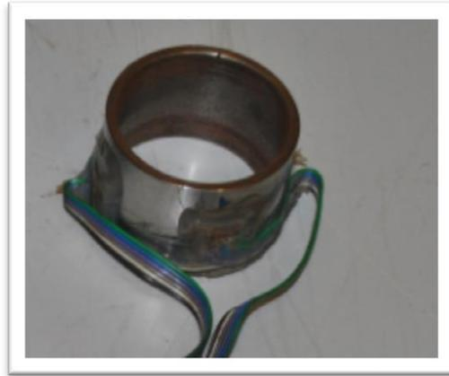
Figura 6. Anillo instrumentado
