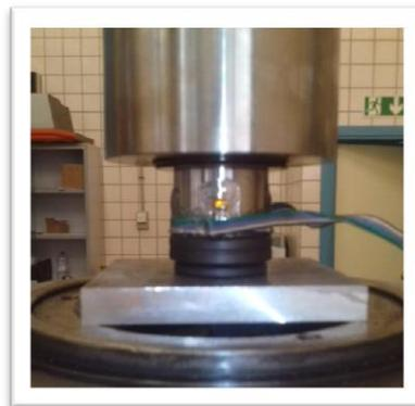
Figura 13. Disposición del anillo en la calibración
