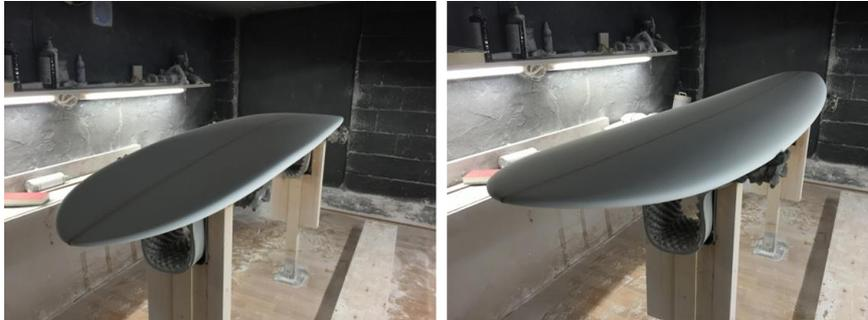
Figura 31. Tabla tras el *shapeado* del *bottom* y *deck*, respectivamente
