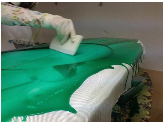
Figura 34. Laminado del bottom
