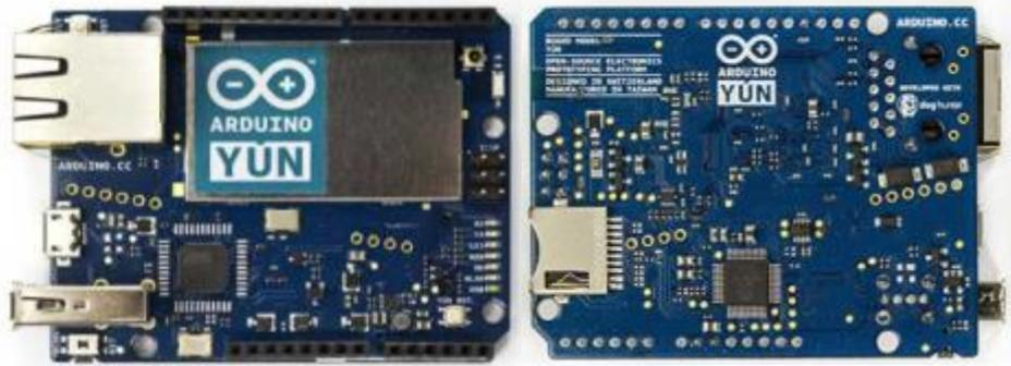
Figura 13 – Vista frontal y trasera Arduino Yún
