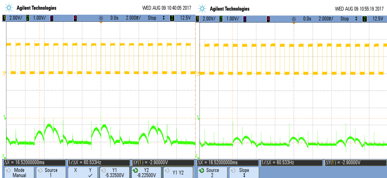
Figura 3-5. Rizado de alimentación Vcc antes(izquierda) y después(derecha)
