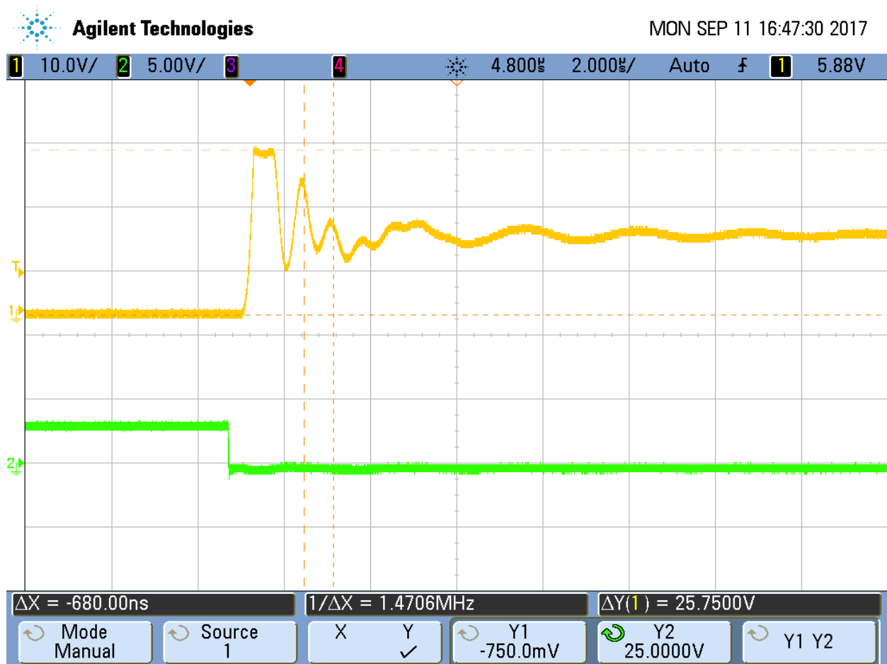
Figura 4-8. Sobreoscilación en el disparo del Mosfet
