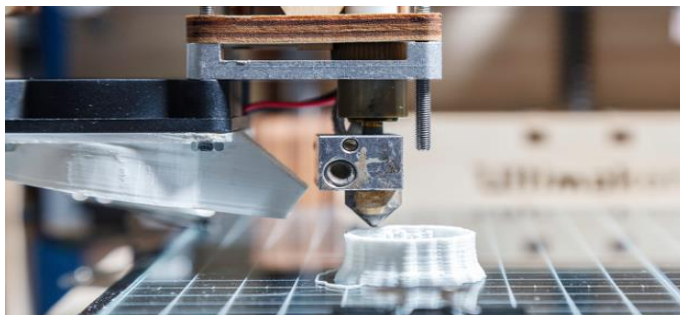
Figura1-4. Impresión por deposición de material fundido
