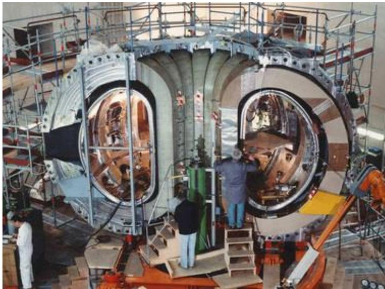
*Figura 3.1.1.1. Siete de las 16 bobinas magnéticas principales del ASDEX durante su montaje (21)*
