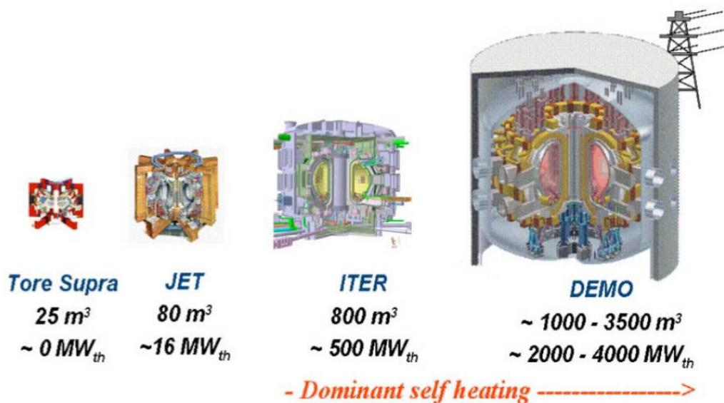
Figura 3.2.4.1 Evolución prevista de los reactores tipo Tokamak (32)
