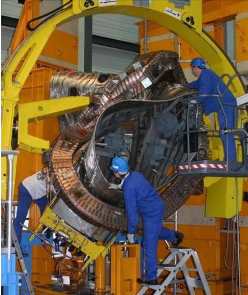
*Figura 3.3.1.1. Bobina magnética del Stellarator Wendelstein 7-X durante su montaje (34)*
