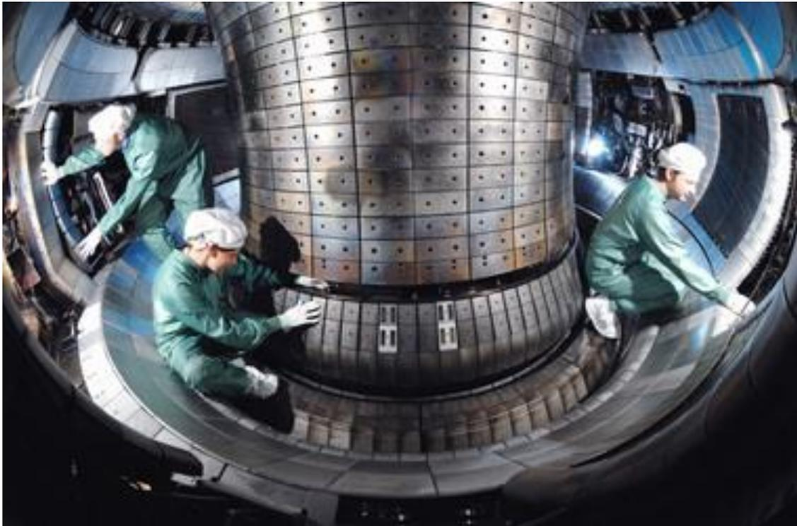
*Figura 3.1.2.1. Trabajadores realizando labores de mantenimiento en el interior de la vasija de un reactor tipo Tokamak (ASDEX) (22)*
