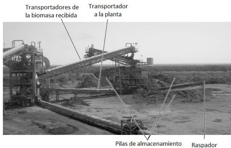
Figura 15: Transporte de la biomasa desde el almacenamiento hasta la planta (20)
