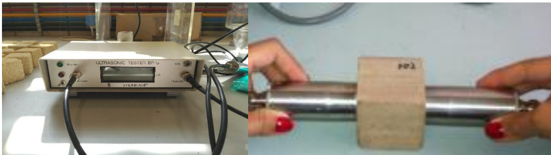
Figura 27. Equipo para medir la velocidad de ultrasonido.
