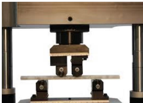
Figura 11. Ensayo de resistencia a la flexión.
