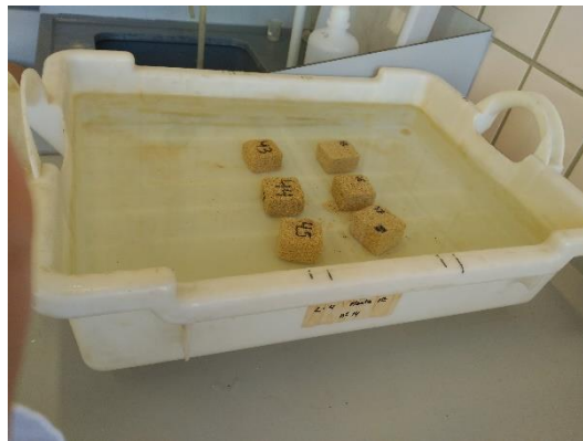
Figura 30. Ensayo de absorción libre de agua por inmersión total.
