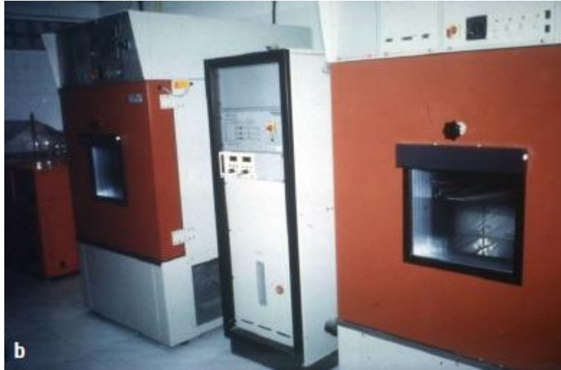
Figura 17. Cámara climática junto a la unidad de dosificación del gas.
