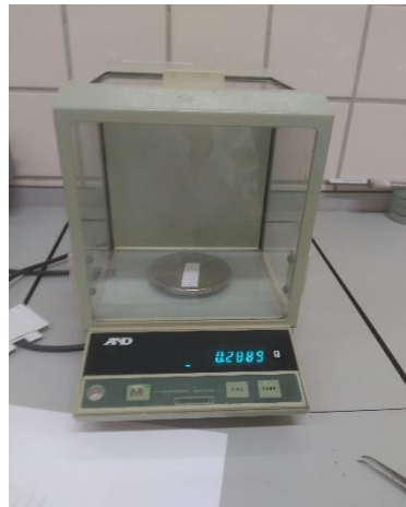
Figura 32. Cálculo peso tiras del Peeling Test.
