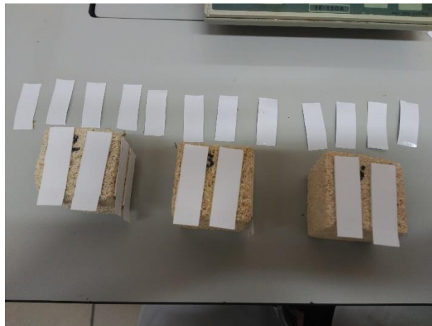
Figura 33. Adhesión tiras a la piedra en el Peeling Test.
