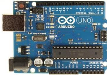
Figura 3-4 Placa Arduino
