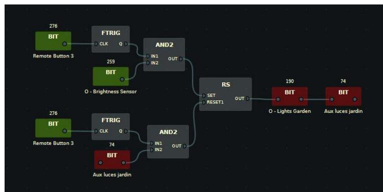
Figura 5-8 Diagrama de bloques del accionamiento de las luces del jardín
