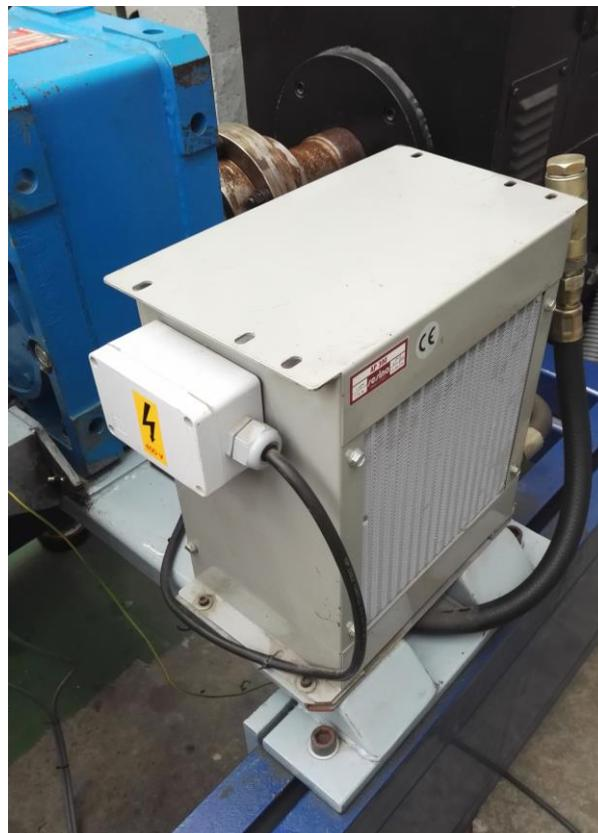
Figura 2-13. Radiador del sistema de refrigeración.
