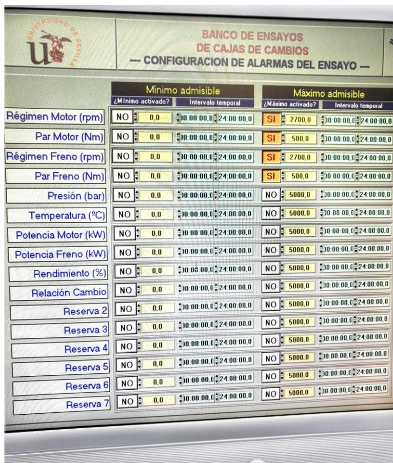
Figura 2-20. Configuración de las alarmas a través del software del banco de ensayos.
