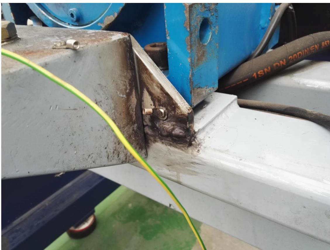
Figura 3-10. Nueva soldadura del lateral derecho.
