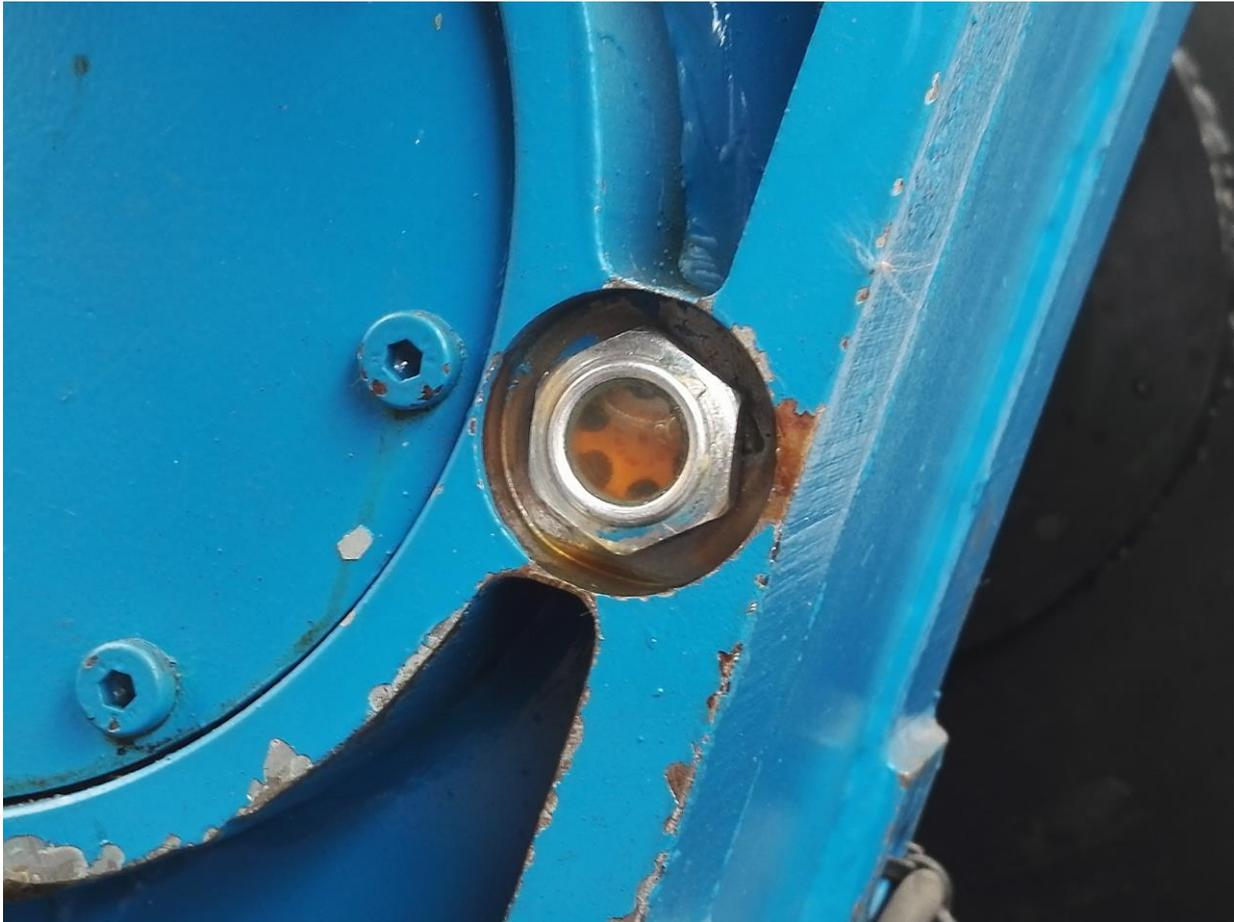
Figura 3-6. Tapón de nivel de aceite lleno del reductor.
