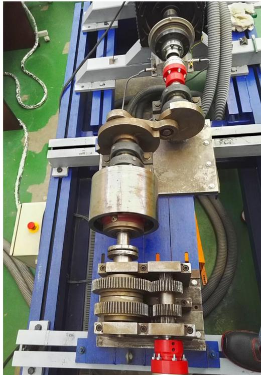
Figura 4-12. Caja de cambios instalada.
