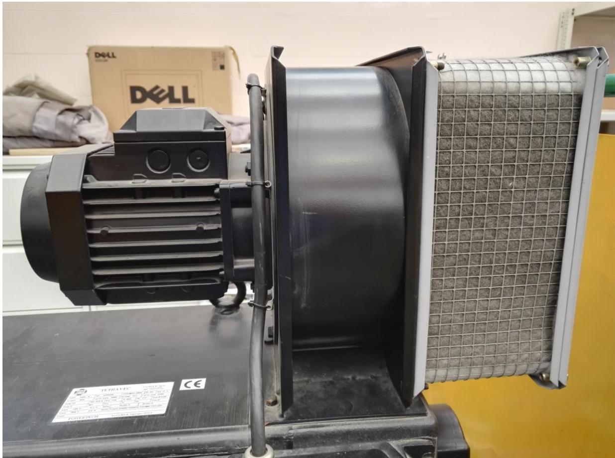
Figura 2-4. Motor eléctrico y ventilador que refrigeran al motor.
