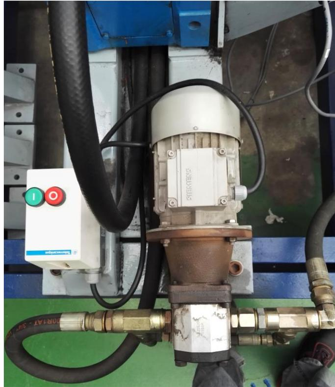
Figura 2-12. Bomba y mando de activo/inactivo del sistema de refrigeración del reductor.
