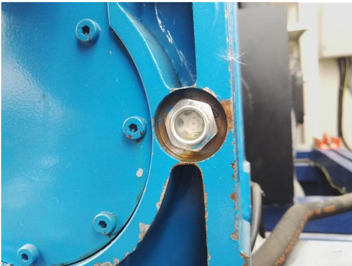
Figura 3-5. Tapón de nivel de aceite vacío del reductor.
