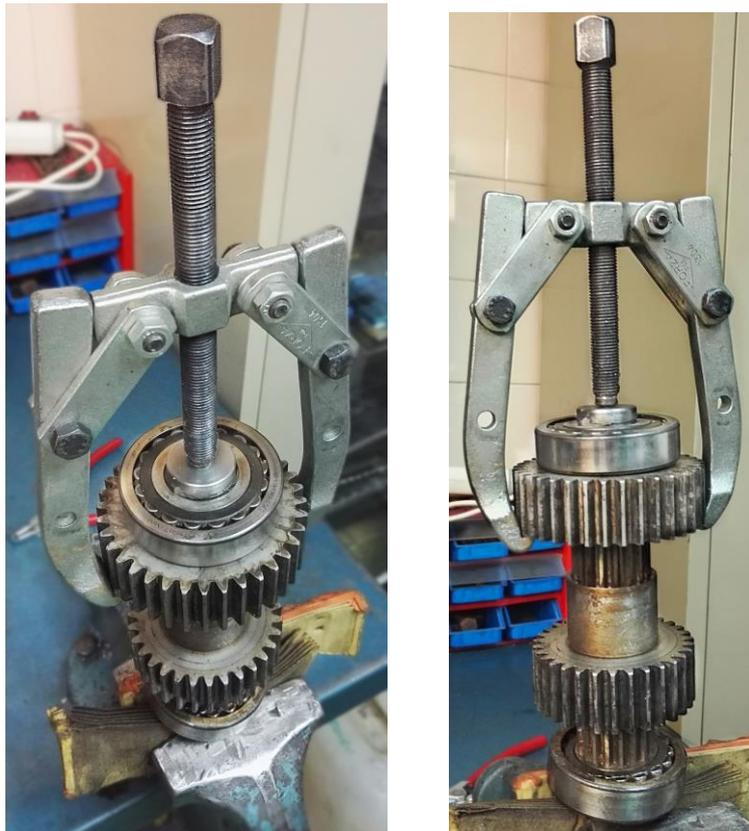
Figura B-4. Herramienta para quitar el rodamiento del eje.
