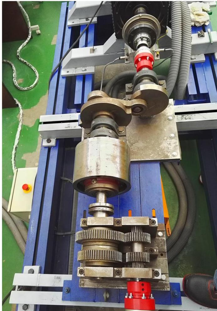
Figura A-3. Comprobando la alineación de la caja de cambios.
