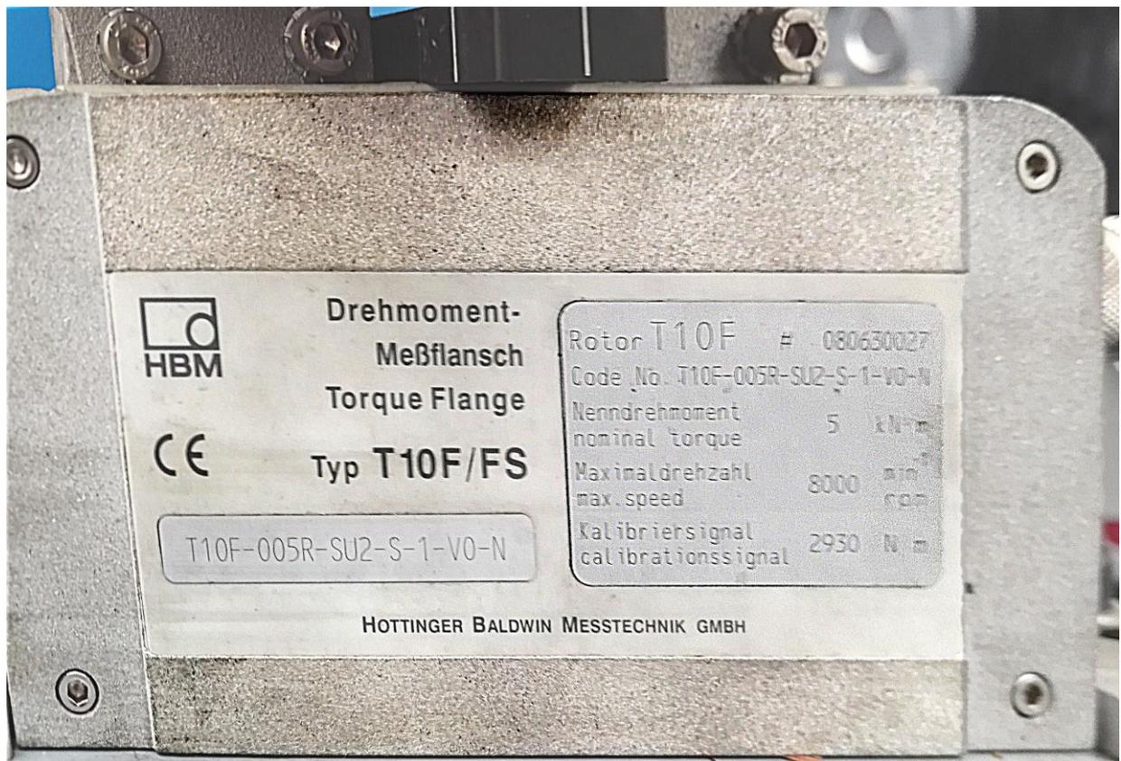
Figura 2-9. Placa de características del medidor de torque del freno.
