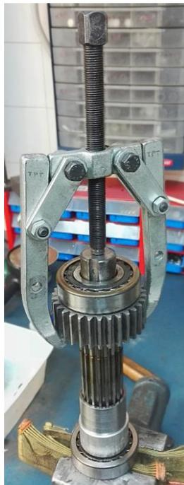
Figura C-2. Retirada del rodamiento opuesto a la primera configuración de bloqueo.
