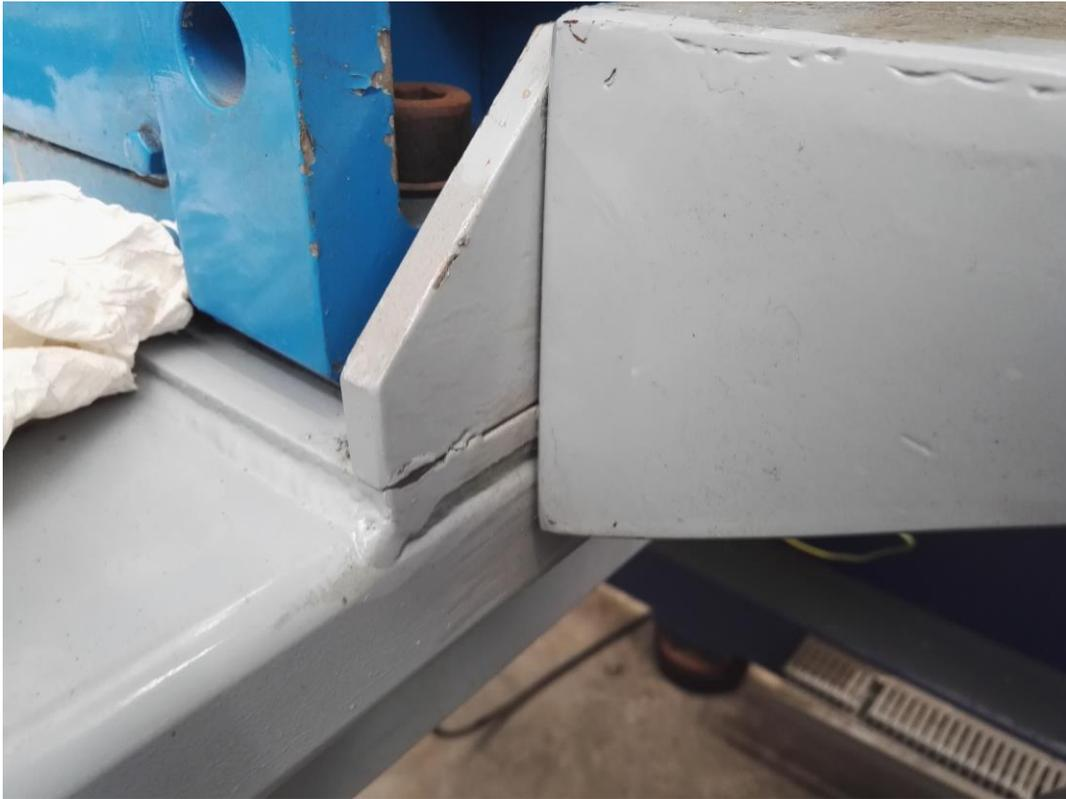
Figura 3-7. Grietas en la soldadura del lateral izquierdo.
