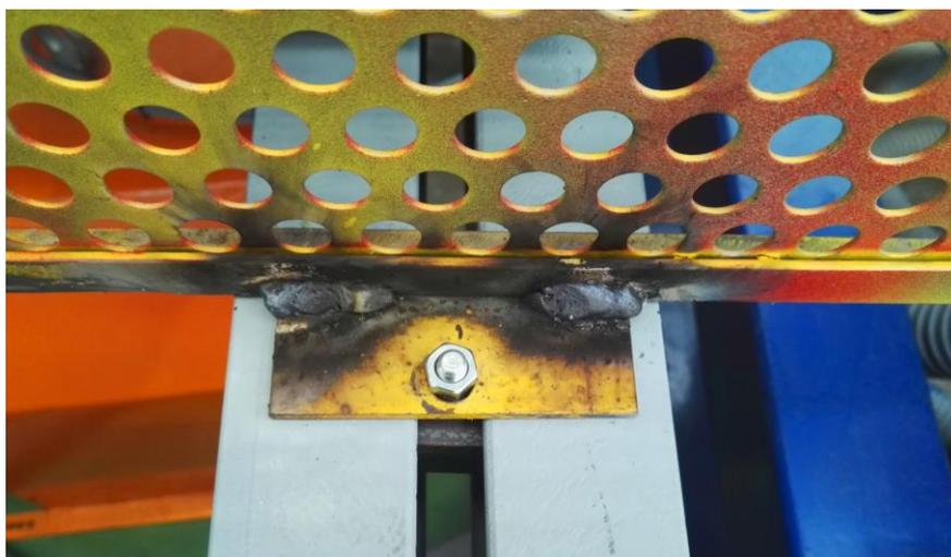
Figura A-5. Nuevo punto de unión entre la jaula de protección y la viga bajo la caja de cambios.
