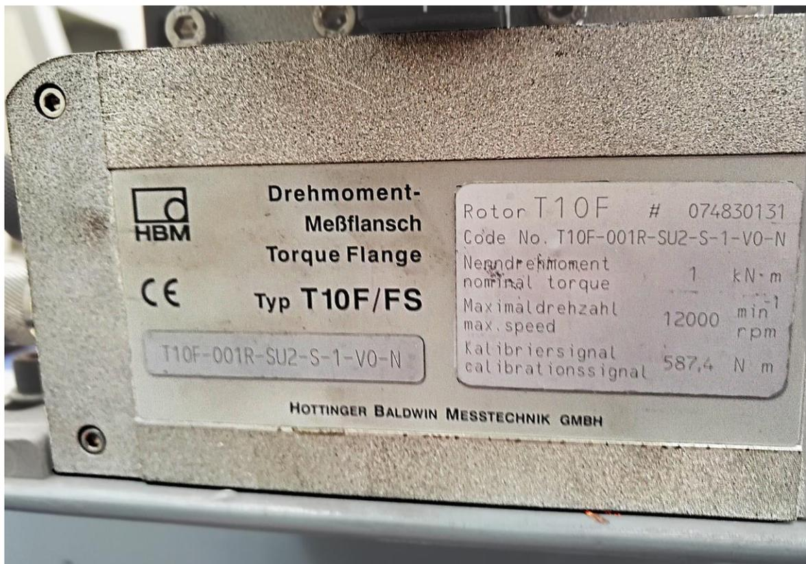
Figura 2-7. Placa de características del medidor de torque del motor.
