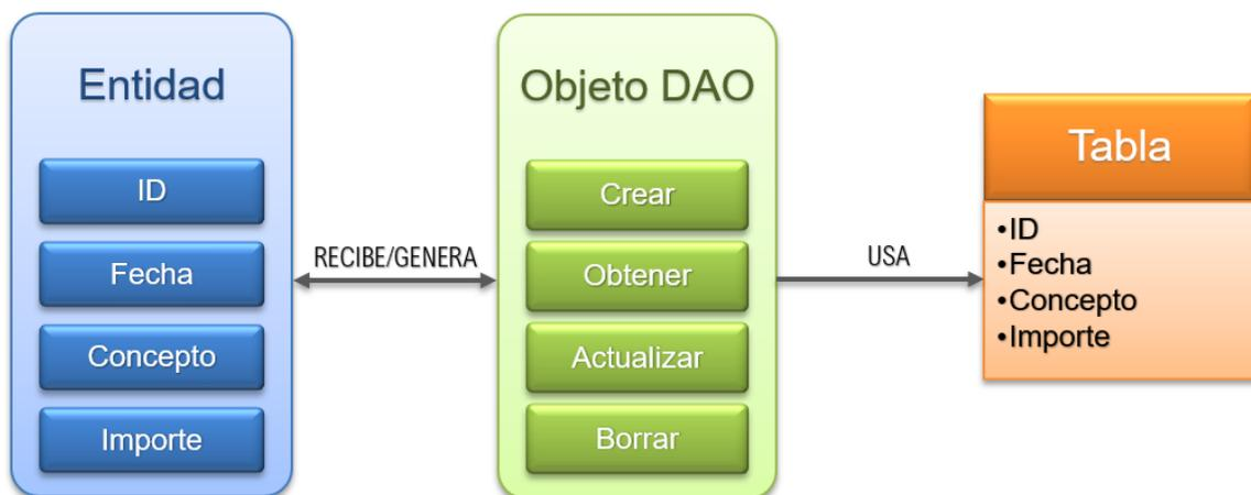
*Ilustración 8: Funcionamiento de los objetos DAO*
