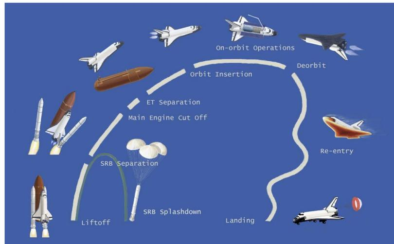
Figura 15: Secuencia de sucesos en la operación del Space Shuttle
