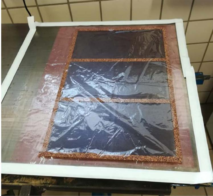
Figura 3-17. Colocación de la segunda capa antiadherente.
