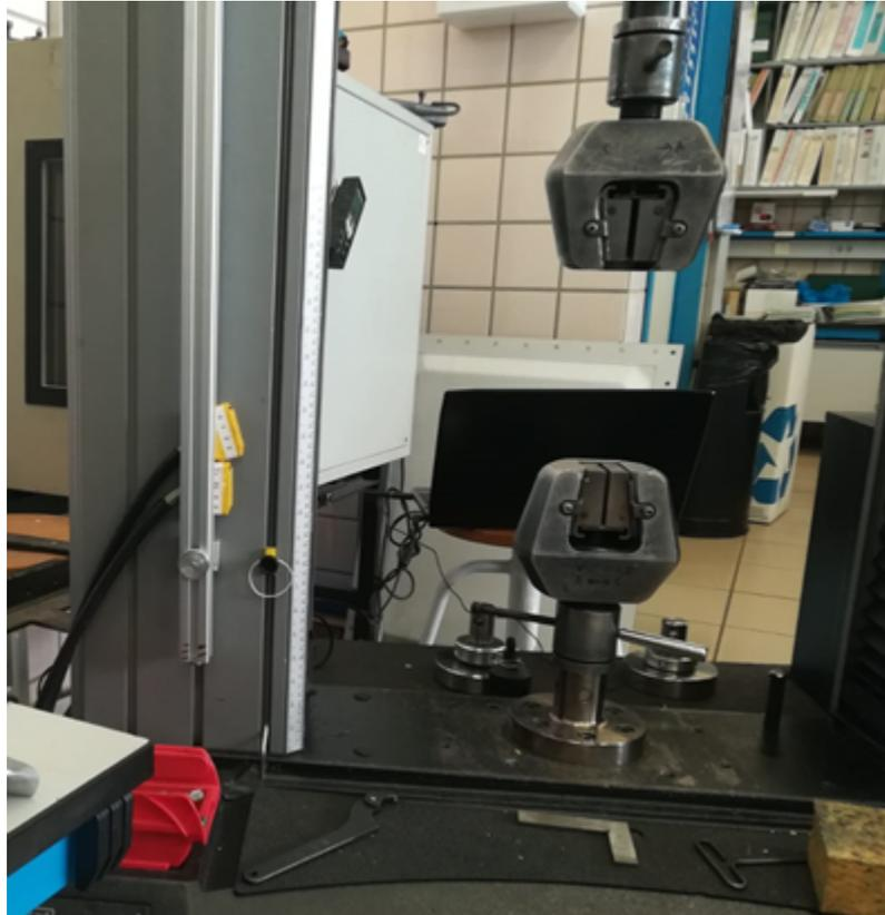
Figura 4-5. Máquina de tracción.
