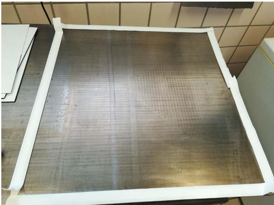
Figura 3-14. Colocación de la cinta de cromato.
