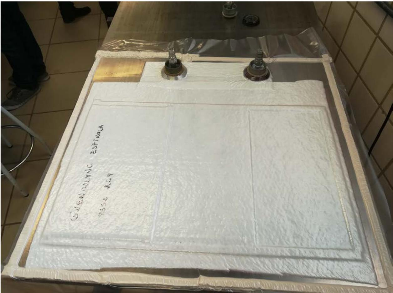
Figura 3-20. Vacío de las placas.
