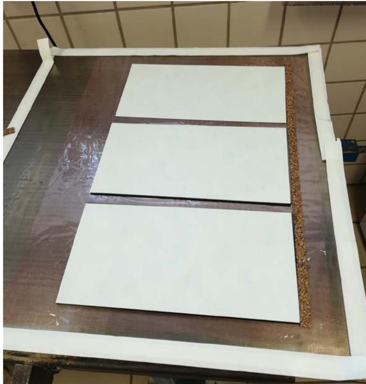
Figura 3-15. Colocación del plástico antiadherente y del corcho.
