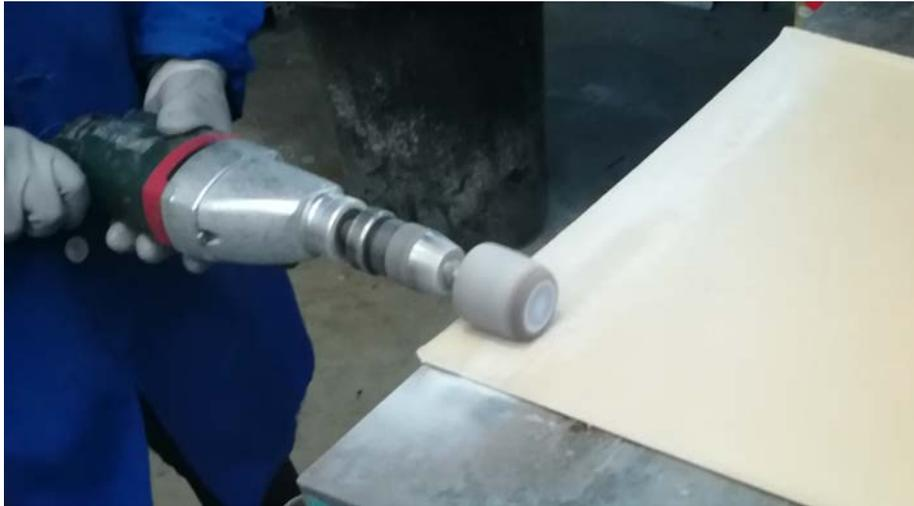
Figura 3-30. Proceso de lijado.
