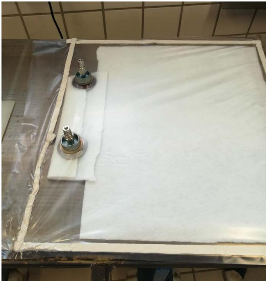
Figura 3-19. Acabado de la bolsa de vacío.
