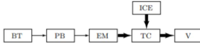
Figura 8: flujo de potencia en híbridos paralelo para  $0 < U < 1$ .
