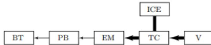
Figura 9: flujo de potencia en híbridos paralelo para frenada regenerativa
