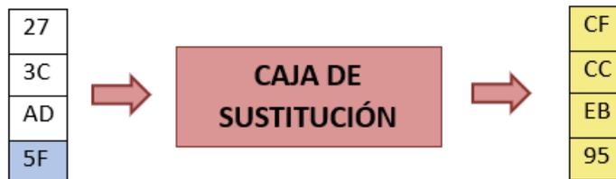
Figura 11. Operación SubBytes sobre clave
