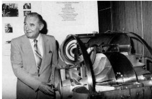
Ilustración 3. Hans von Ohain con el primer turborreactor [5]
