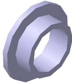
Ilustración 24. Modelo de espaciador delantero en CATIA V5
