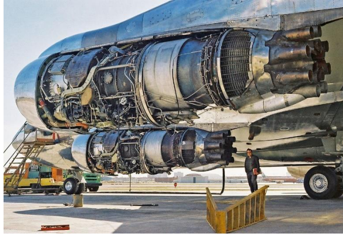
Ilustración 4. Rolls Royce Conway en un Boeing 707 [6]
