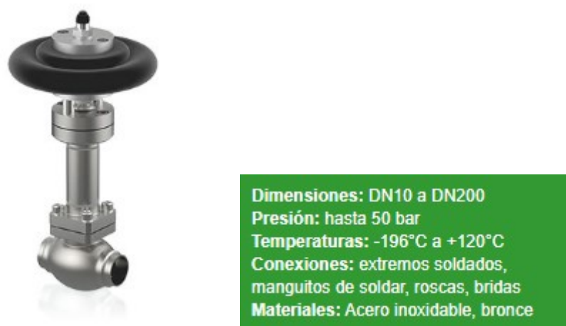
Figura 11. Válvula con actuador neumático
