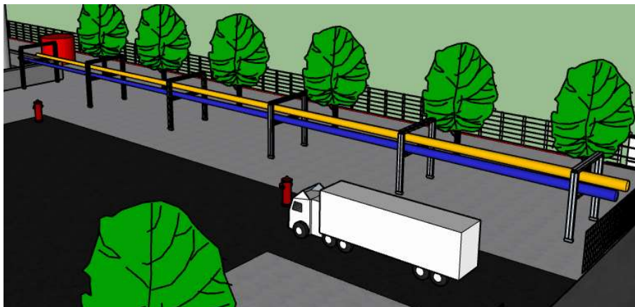
Figura 4-16. Rack de tuberías 3
