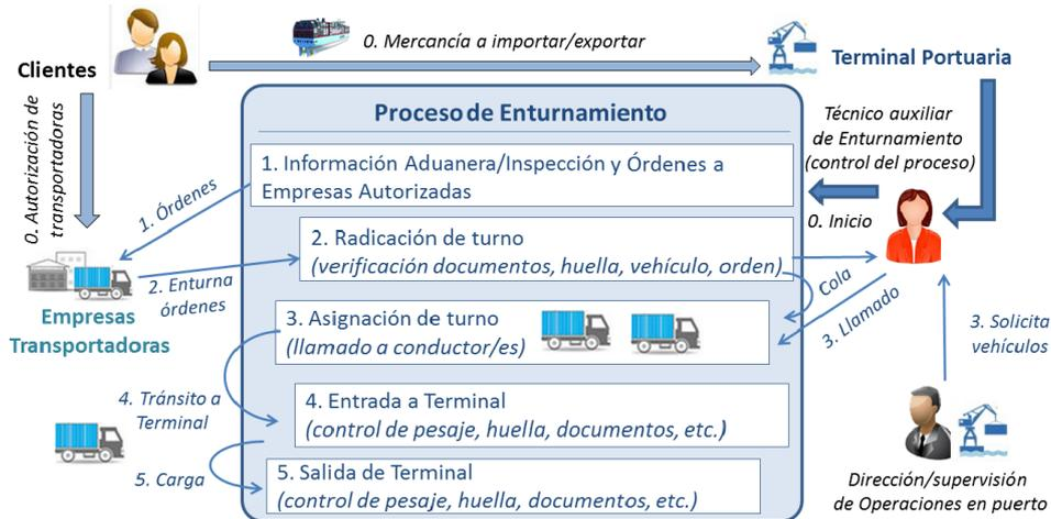
Figura 28. Procesos de entrada/salida de vehículos de terminal para proceso de enturnamiento
