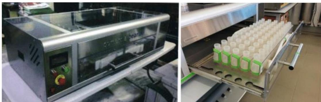
*Figura 3-31: Sistema de dosificación de reactivos automatizado*
