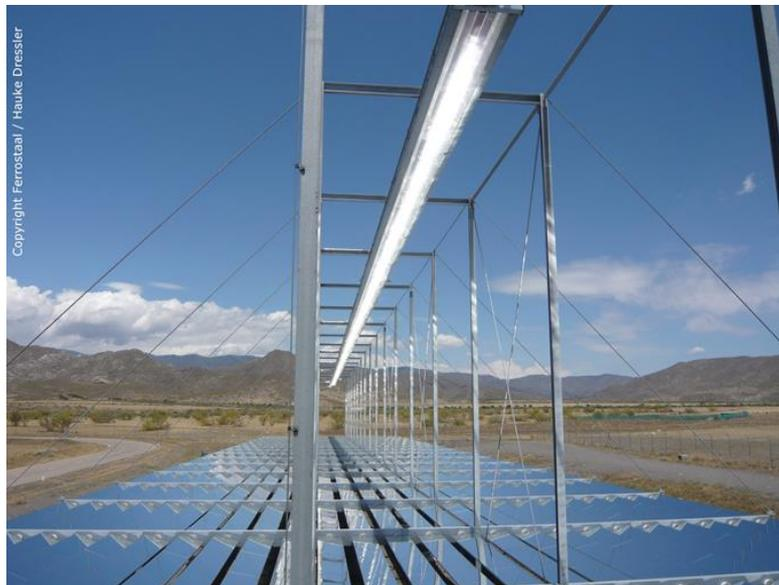
*Figura 9. Colector lineal Fresnel, Plataforma Solar de Almería, Ferrostaal [33].*
