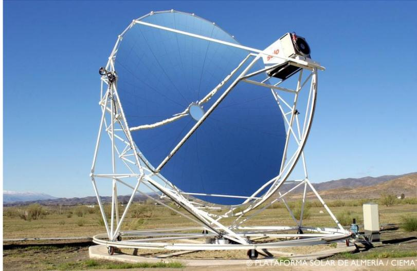
*Figura 8. Discos parabólico real con motor Stirling, Plataforma Solar de Almería [33].*
