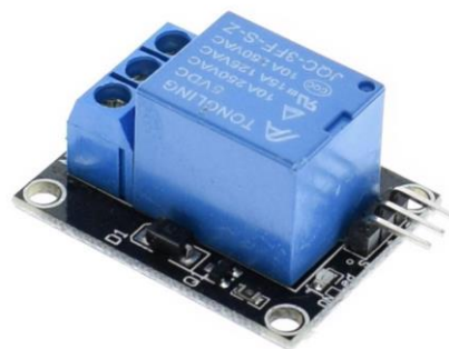
Ilustración 3-6 Relé de un solo contacto
