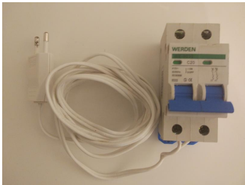
Ilustración 4-16 Conexión entre la red eléctrica y el interruptor general
