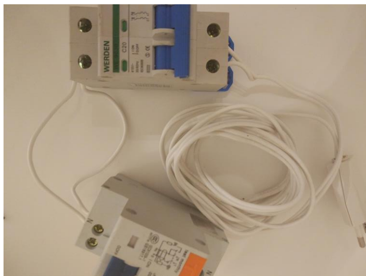
Ilustración 4-17 Conexión entre interruptor general y diferencial
