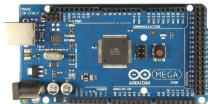
Ilustración 3-1 Placa Arduino Mega2560
