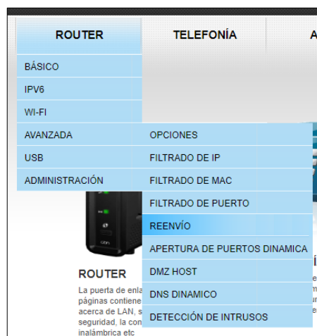
Ilustración 0-2 Acceso a la configuración de reenvío del router
