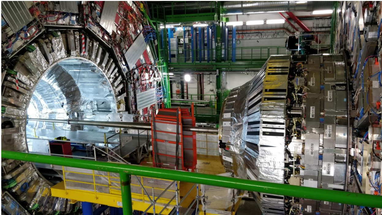
Figure 4: Imagen de uno de los dos Calorímetros del CMS (derecha). Tubo haz de partículas (izquierda)
