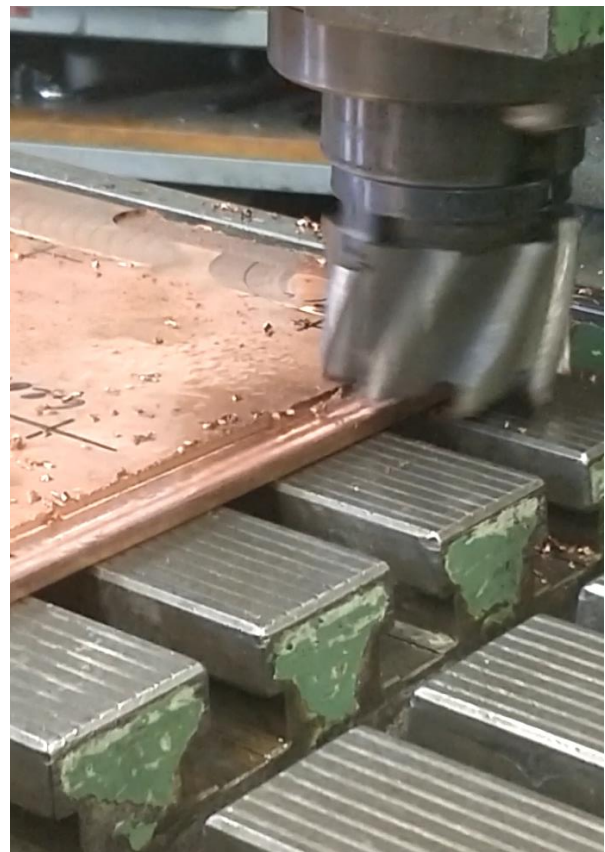
Figure 20: Diferentes operaciones de fresado sobre la placa de cobre tras las soldadura por vacuum brazing
