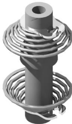
Figure 39: Montaje final sistema de fijación Módulo hexagonal-Coperplate
