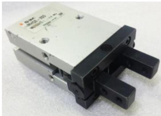
Figura 2: Pinza neumática *MHQ2-20D*
