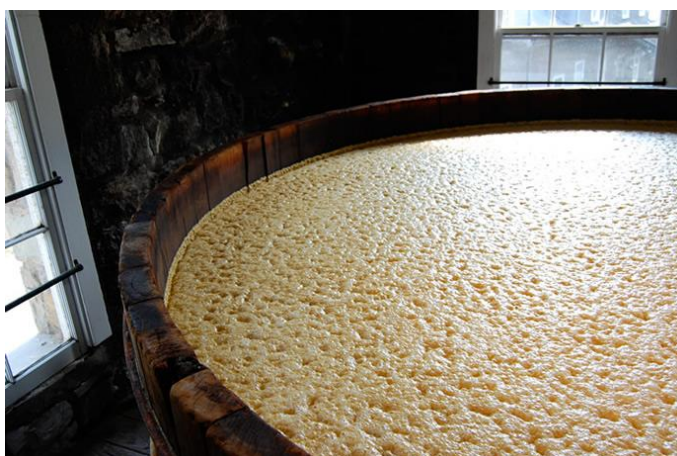
Figura 7: Espuma creada por la acción de la levadura en fermentador abierto [13]
