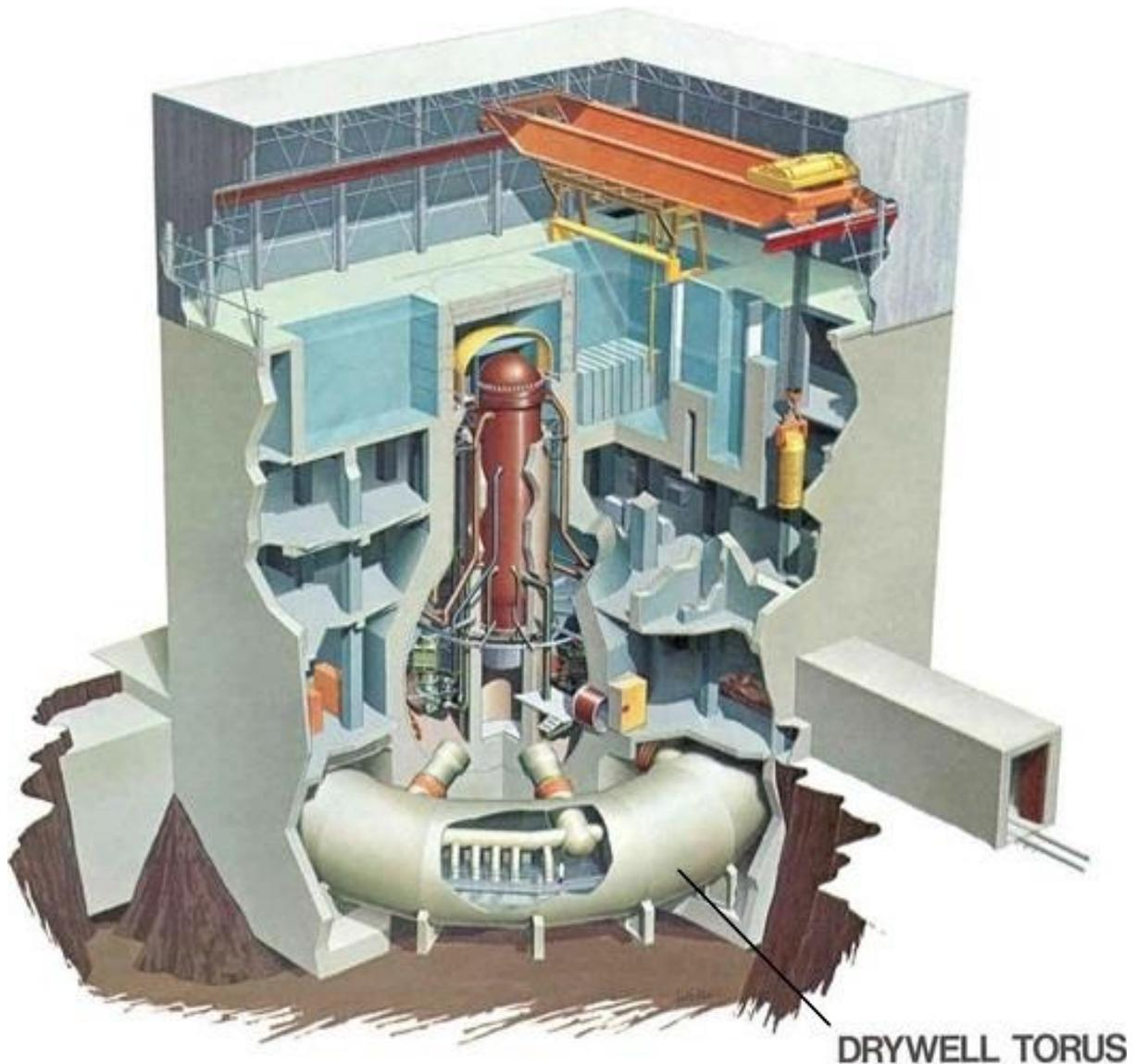
**Figura 2-24.** Esquema del toro de un reactor de agua en ebullición. Cortesía de General Electric.
