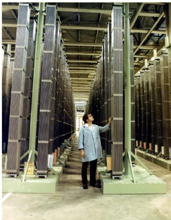
**Figura 2-16.** Foto de un elemento combustible de un PWR. Cortesía de Westinghouse Corporation.
