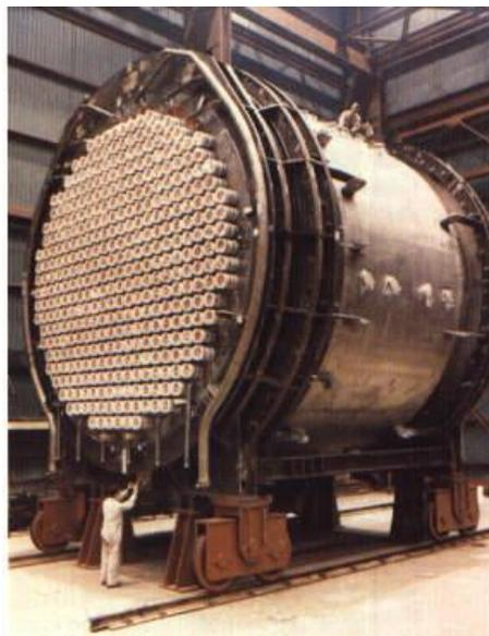
*Figura 2-33. Foto de un reactor de agua pesada. Cortesía de AECL*
