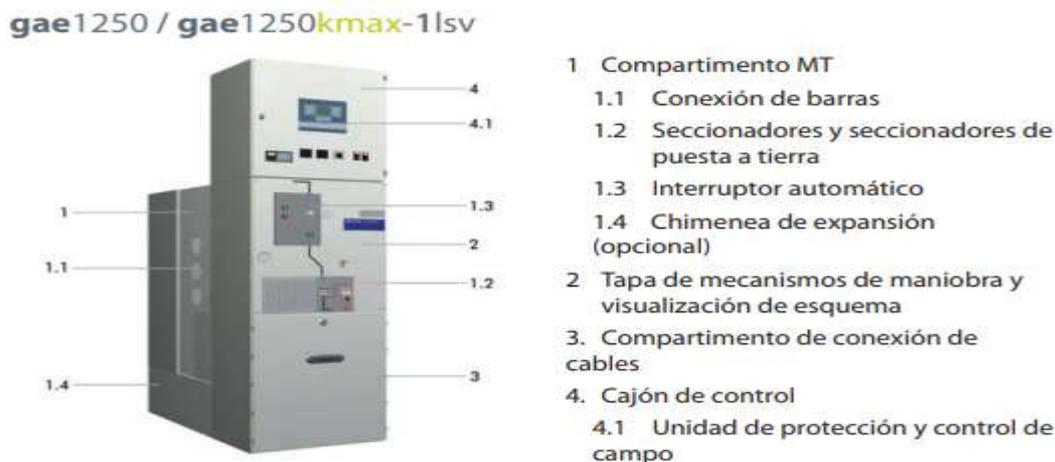
Figura 36. Estructura constructiva y componentes de celdas Ormazabal gae1250kmax-1lsv [12]
