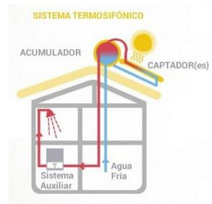
Figura 28. Instalación con circulación natural (Click Renovables)
