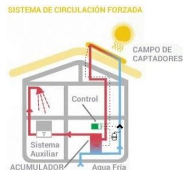
Figura 29. Instalación con circulación forzada
