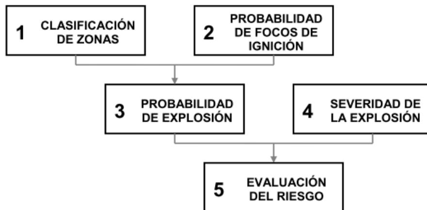
Figura 7-1: Esquema de evaluación del riesgo de explosión
