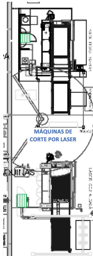
Figura B-6: Zonas classificadas em máquinas de corte por laser (Filtros)
