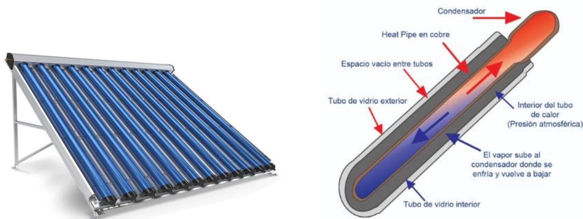
Figura 3-3. A la izquierda, panel solar de tubos de vacío. A la derecha, tubo solar térmico de vacío tipo Heat Pipe. *Fuente: SOPELIA.*
