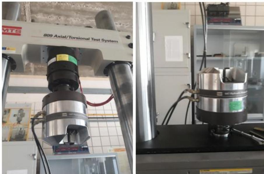
Figura 4-10. Equipo usado para el ensayo de flexión en cuatro puntos.
