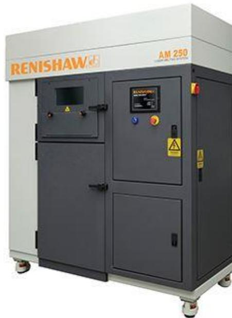
Figura 4-2. Sistema Renishaw AM250 SLM (Sistema de fabricación de las muestras) [30].
