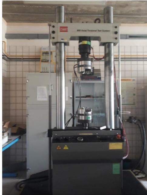
Figura 4-9. Equipo usado para el ensayo de flexión en cuatro puntos.
