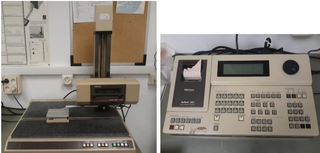
Figura 4-39. Rugosímetro del CAM.
