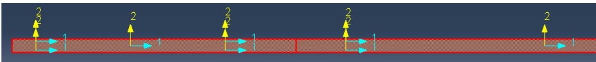
Ilustración 4-4: Orientación del material VCCT.
