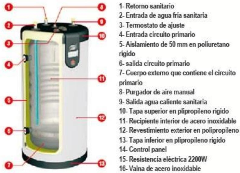
Figura 18. Partes de un acumulador solar
