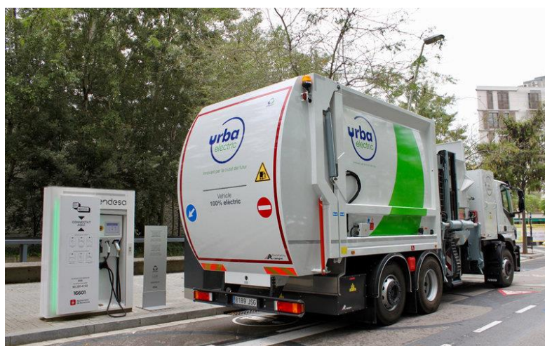
Figura 24. Camión de la basura eléctrico y punto de recarga. Fuente: (Endesa, 2017).
