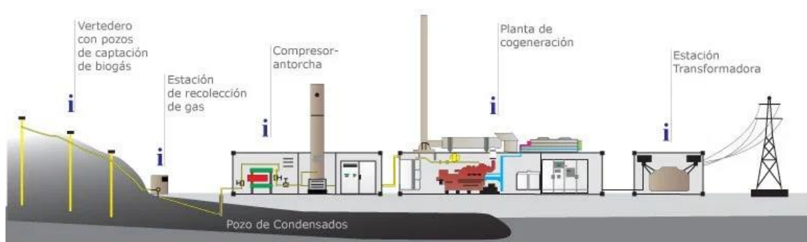
Figura 23. Esquema de una instalación de aprovechamiento energético del biogás producido en el vertedero. Fuente: (Home Jerez, 2014).
